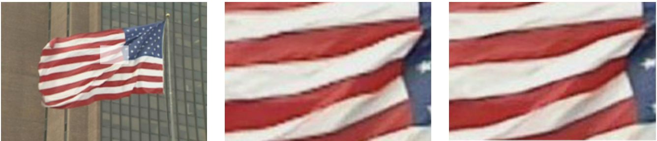
Fig.6 Aplicación de del algoritmo DCDi (imagen original - DCDi apagado - DCDi conectado)
