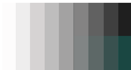
Fig.23 Pantalla combinada con y sin el último bit de rojo
