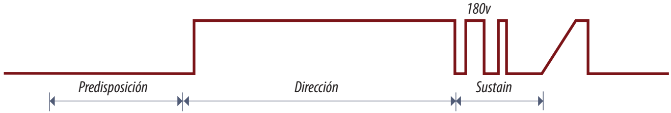
Fig.10 Señal (Z) común a todos los electrodos pares de la pantalla
