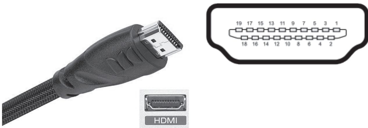
Fig.8 Conector HDMI tipo A visto desde el frente
