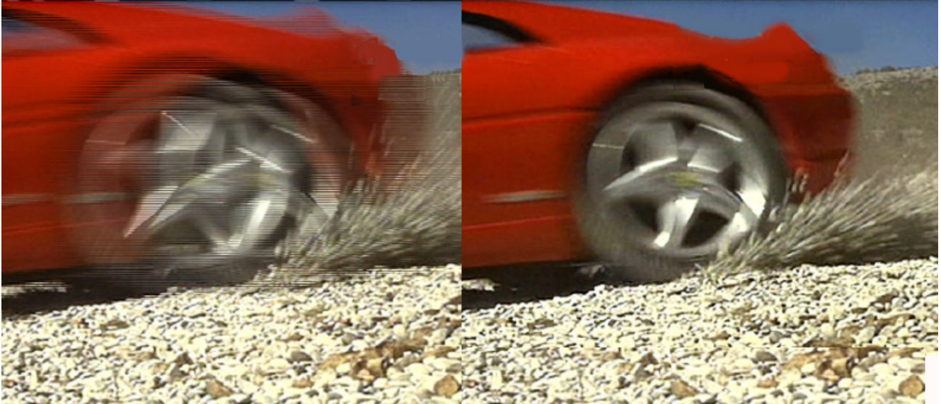
Fig.4 Corrección por Motion Adaptive (sin corregir - corregido)
