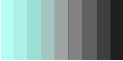
Fig.24 Falta del bit más significativo de rojo
