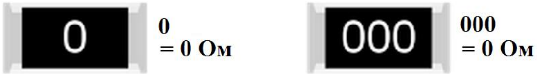
Fig. 5 resistori a chip di marcatura
