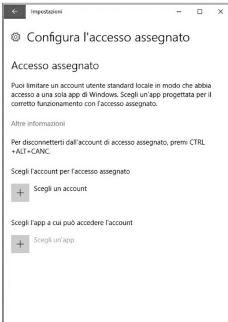
Figura 21.5 Dopo aver selezionato un account da utilizzare per l'accesso assegnato, selezionate anche l'app che verrà eseguita automaticamente.
