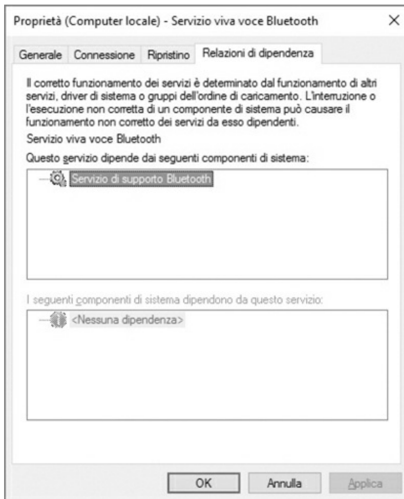
Figura 18.9 La scheda Relazioni di dipendenza mostra le dipendenze (da altri servizi o driver) del servizio selezionato.
