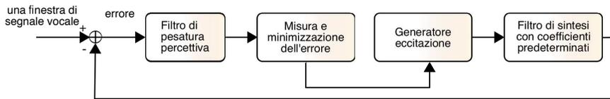
Figura 21.13: Schema di codifica vocale ABS - Analysis by Synthesis
