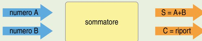
dispositivo ha due linee di ingresso sulle quali vengono connessi i segnali dei due bit da sommare e due linee in uscita, la prima che riporta la somma dei valori in ingresso e la seconda per il riporto.
