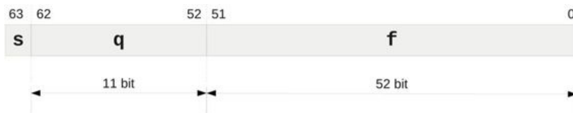
Figura 2.2 - Significato dei bit di un floating-point in doppia precisione secondo lo standard IEEE 754.
