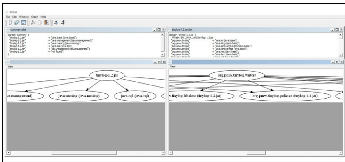
Figura 13.8 Visualizzazione del grafo delle dipendenze di tinylog-1.2.jar ottenuto con il software Graphviz.
