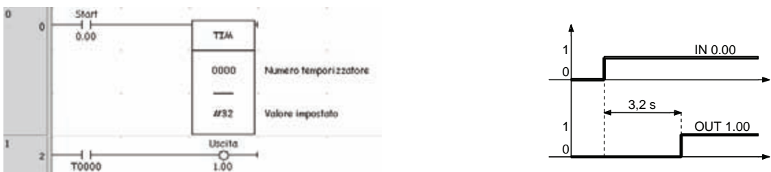
Fig. 4.2 - Esempio di utilizzo di un Timer: il segnale di Start 0.00 eccita l'uscita 1.00 dopo 3,2 s.
