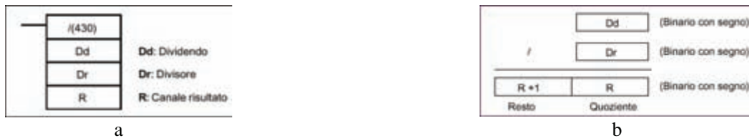
Fig. 4.43 - Istruzione di divisione: a) Divisione binaria (/) - b) Il risultato della divisione viene posto in due canali consecutivi e suddiviso in quoziente e resto.
