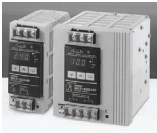
Fig. 1.5 - a) Alimentatori switching compatti Omron serie S8VS: Tensione di ingresso da 100 a 240 V AC, 50/60 Hz. Tensione in uscita 24 V DC. Potenza in uscita da 60 W a 240 W a seconda dei modelli. Montaggio su guida DIN. Display a LED a sette segmenti a tre cifre utilizzato per il monitoraggio dello stato dell'alimentatore (es. tensione, corrente, ecc.) - b) Pannello frontale del modello S8VS-12024A, (120 W), con display e funzione di controllo previsione di manutenzione.
