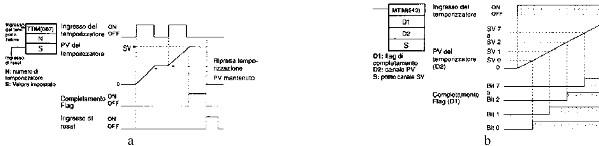
Fig. 4.9 - a) Funzionamento dei temporizzatori TTIM (087) - b) Funzionamento dei temporizzatori MTIM (543).
