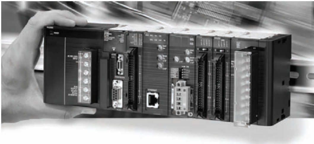
Fig. 1.35 - Esempio di PLC modulare CJ1M. Da sinistra: modulo alimentatore (PA205R), modulo CPU (CJ1M-CPU23), modulo Ethernet (ETN11), modulo bus di campo DeviceNet (DRM21), modulo digitale ad alta densità con 32 ingressi 24 V DC, modulo digitale ad alta densità con 32 uscite a transistor PNP, modulo analogico con 8 ingressi. Si noti come questo controllore abbia dimensioni particolarmente compatte e preveda per il suo montaggio una comune guida DIN.
