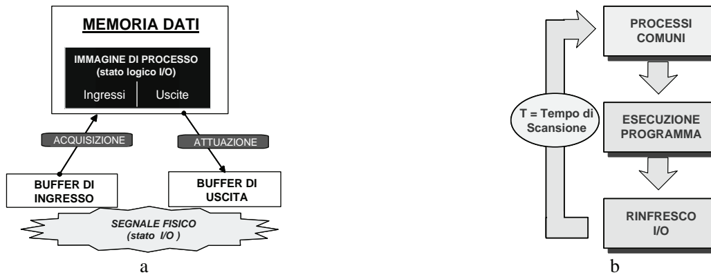
Fig. 1.7 - a) Elaborazione dei dati da parte di un PLC - b) Tempo di scansione.
