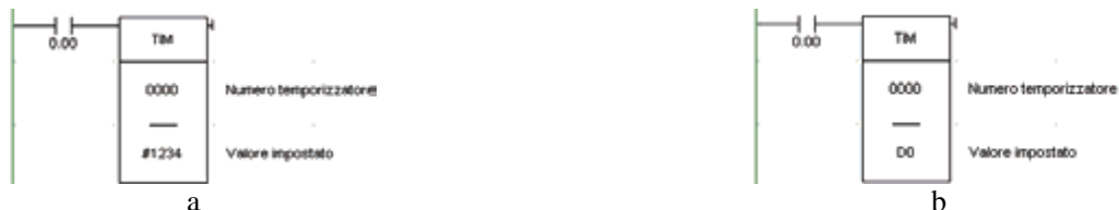
Fig. 4.68 - Esempi di parametri di un'istruzione: a) Costante - b) Indirizzo diretto ad una variabile. Il Set Value del temporizzatore sarà uguale al valore presente nel canale D0. Se ad esempio D0 vale 1234 anche SV sarà uguale a 1234.
