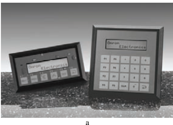
Fig. 1.31 - a) Visualizzatore di messaggi con tasti funzione - b) Terminali grafici tipo touch screen.
