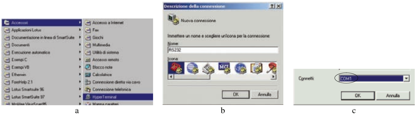
Fig. 4.101 - a) Avvio dell'Hyper Terminal - b) Descrizione della connessione RS232 - c) Selezione della porta di comunicazione COM1.
