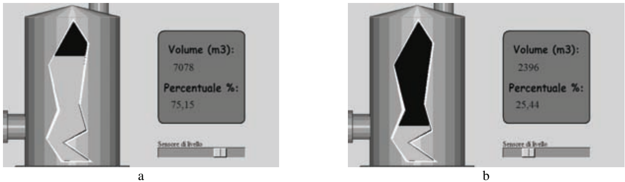
Fig. 4.61 - Simulazione n° 7, conversione del valore analogico in ingresso in un valore che rappresenta il volume di un serbatoio espresso in \text{m}^3 , la simulazione consente muovendo il cursore, che simula il sensore di livello, di variare il volume e la percentuale di riempimento del serbatoio.
