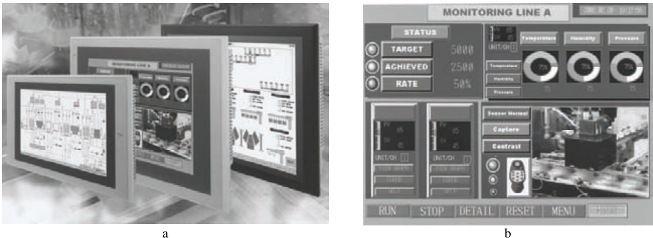
Fig. 1.32 - a) Terminali grafici ad alta risoluzione adatti per la supervisione di impianti automatici di medie dimensioni - b) Esempio di pagina grafica con pulsanti, grafici e visualizzazione di valori. Si noti, in basso a destra, la finestra che mostra, mediante l'uso di una telecamera, la fase di una lavorazione.
