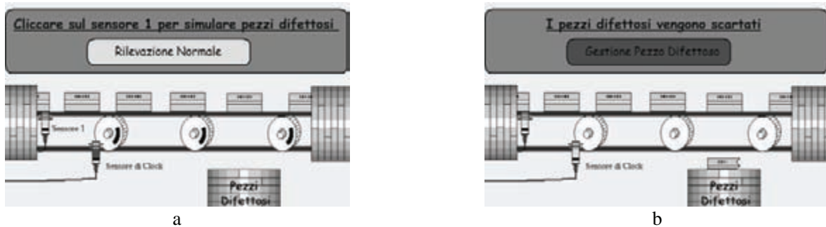
Fig. 4.24 - Simulazione n° 4, esempio di controllo di qualità su di un nastro trasportatore: a) Rilevazione normale - b) Scarto di un pezzo difettoso.
