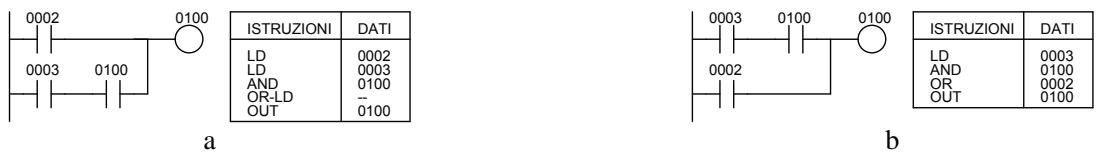
Fig. 3.25 - Esempio di diagramma ladder riscritto per risparmiare memoria e tempo di scansione (1).
