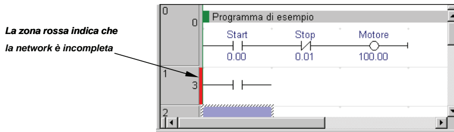
Fig. 3.82 - CX-Programmer: La zona rossa indica che la network è incompleta.
