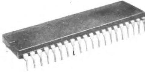
Fig. 12.7 Un circuito integrato per uno strumento digitale da pannello (riprodotto per concessione della RS Components Ltd)
