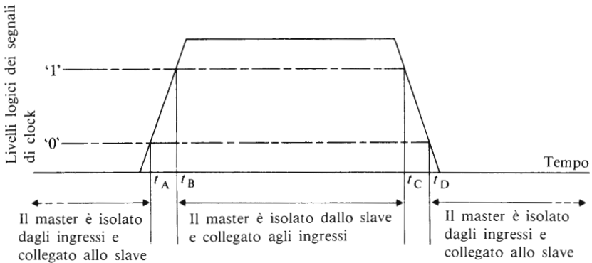
Fig. 5.8 Sequenza operativa di un flip-flop master slave in termini di impulso di clock
