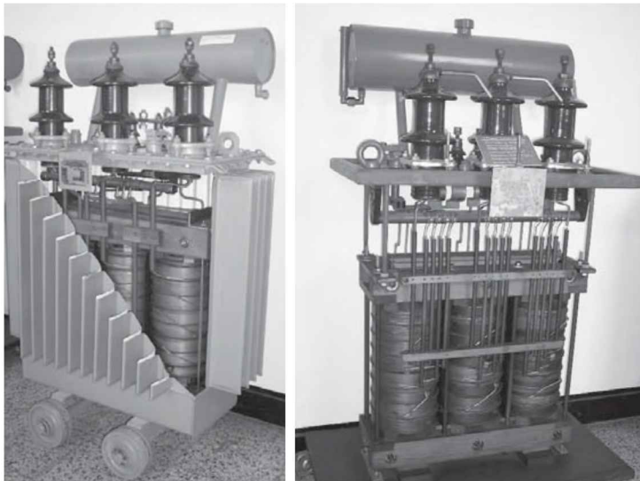
■ Fig. 4.40 Esempio di trasformatore trifase a tre colonne in olio (con contenitore e senza contenitore) (da wiki-commons).
