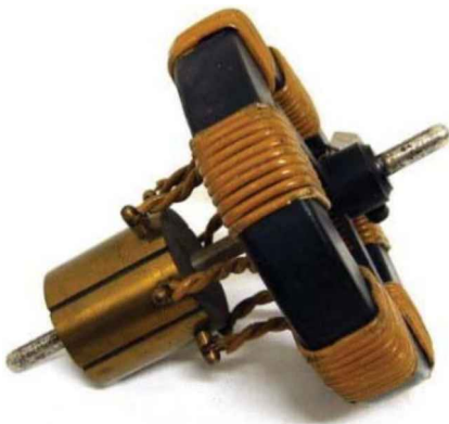
■ Fig. 6.5 Rotore con avvolgimento ad anello di Pacinotti
