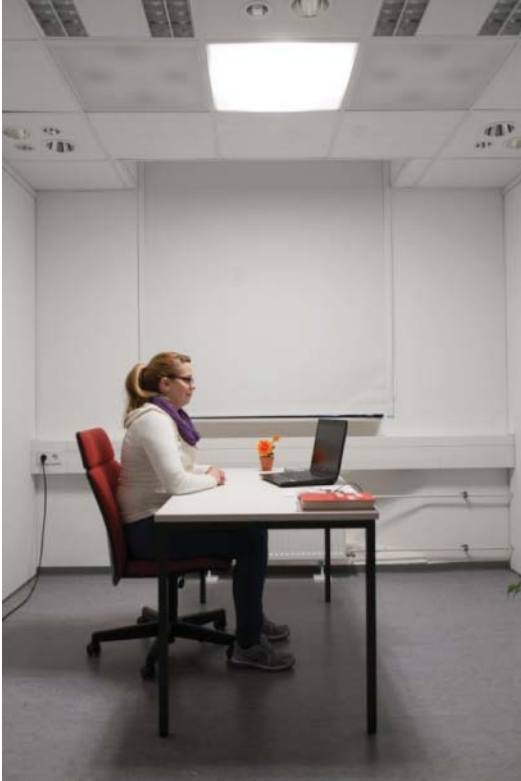
Figure 5.69 Experimental room to test flicker perception. (Image source: Technische Universität Darmstadt.)
