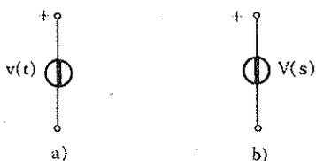
Fig.III.3.1 - Trasformazione nel dominio di Laplace del generatore indipendente di tensione. Le dimensioni di  $v(t)$  sono Volt e di  $V(s)$  sono Volt  $\times$  secondo.
