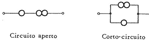
Fig. 1.8.8 - Circuiti equivalenti del corto-circuito e del circuito aperto, ottenuti tramite il nullatore ed il noratore.
