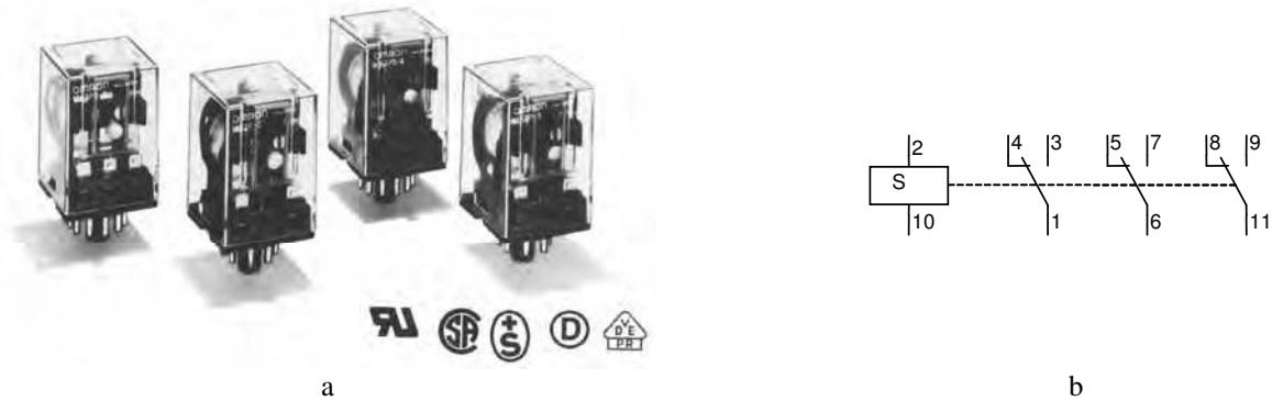
Fig. 2.122 - Esempio di relè monostabile tipo MK3P: a) Alcuni modelli disponibili - b) Collegamenti. Questi relè sono reperibili in commercio con i terminali ad innesto, con 2 o 3 contatti in deviazione, indicatore meccanico o a diodo LED e pulsante di prova. Sono disponibili modelli con bobina funzionante in AC (6÷240 V) o DC (6÷110 V). La corrente massima di passaggio è di 10 A, mentre la tensione massima di funzionamento è di 440 V AC e 250 V DC (Omron).
