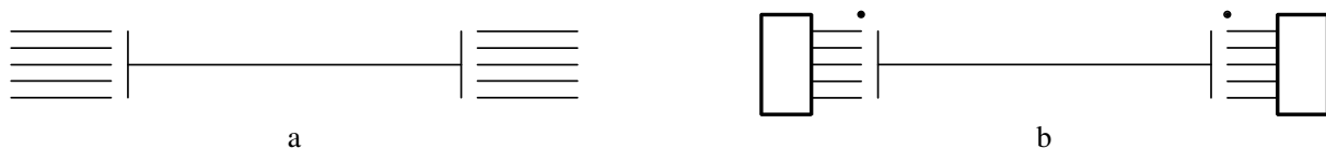
Fig. 1.22 - a) Esempio di conduttori raccolti in gruppo - b) Esempio di conduttori raccolti in gruppo (il punto indica la prima linea di connessione).
