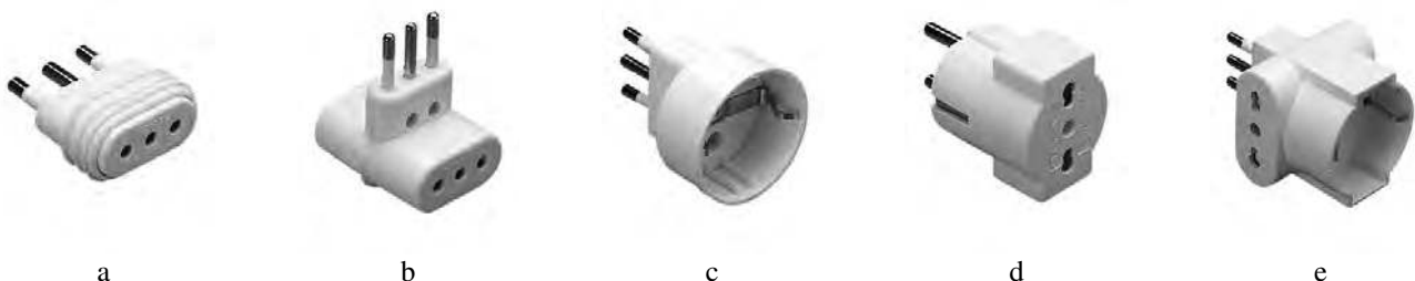
Fig. 2.115 - Esempi di adattatori (250 V AC, max. 1500 W): a) Adattatore semplice con una uscita da 10 A con schermi di sicurezza - b) Adattatore multiplo con due uscite laterali con schermi di sicurezza, 10 A - c) Adattatori semplici con una uscita 16 A UNEL con terra laterale e centrale 10 A - d) Adattatore semplice spina UNEL con una uscita 16 A bivalente - e) Adattatore multiplo con due uscite bivalenti e una uscita UNEL bivalente con terra laterale e centrale (Gewiss).
