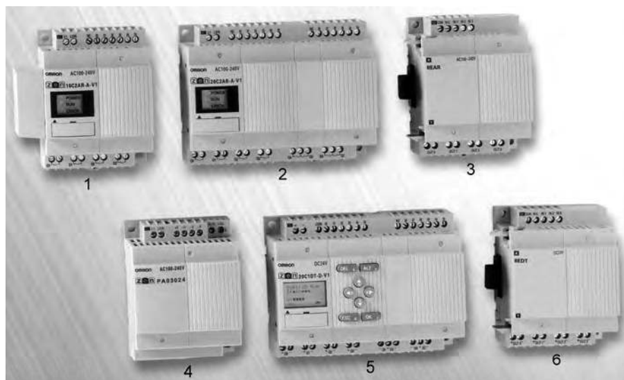
Fig. 6.243 - Alcuni modelli dei relè programmabili ZEN. Si noti, nelle unità centrali sotto il display, il tappo di chiusura che protegge il connettore, il quale consente il collegamento mediante un cavo/interfaccia ad un personal computer per la programmazione. Tale connettore è utilizzabile anche per alloggiare una memoria per il salvataggio dei programmi (Omron).
