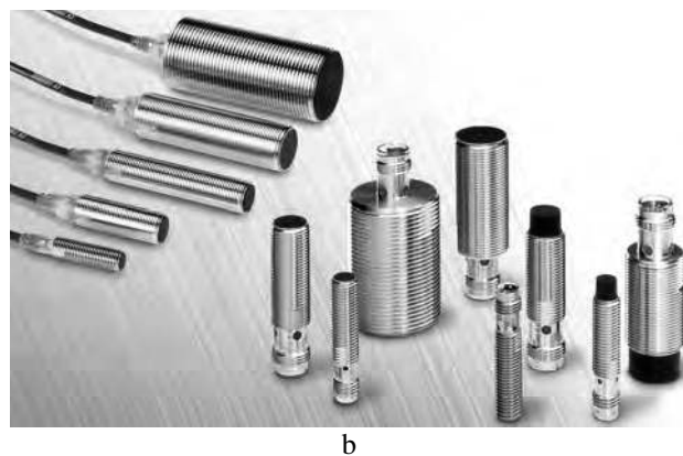
Fig. 6.143 - a) Distanza di rilevamento nominale S_n (in millimetri) tipica di rilevamento degli interruttori di prossimità schermati (S) e non schermati (N) in relazione al diametro del sensore - b) Interruttori di prossimità induttivi con corpo cilindrico di metallo. A sinistra con cavo di collegamento precablato, a destra con connessione standard con connettori M8 o M12. Sempre a destra sono mostrati i modelli schermati e non schermati (Omron).
