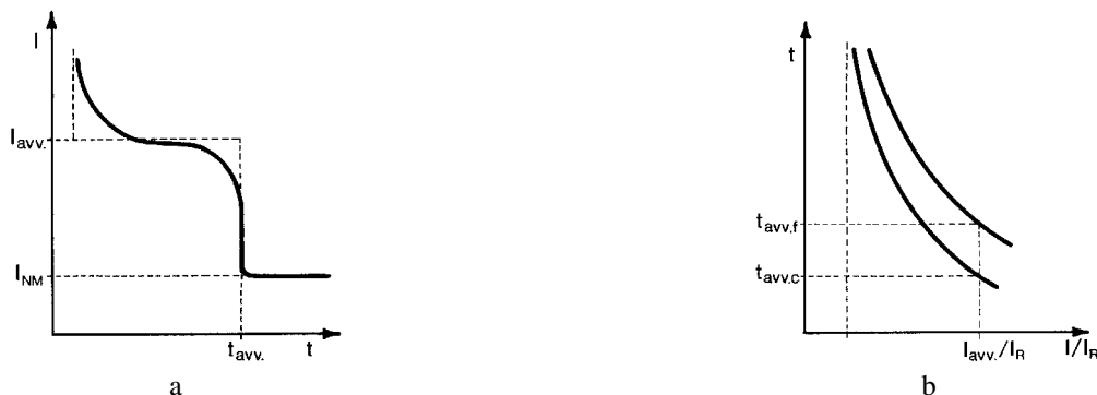
Fig. 6.44 - a) Caratteristica corrente assorbita - tempo di un motore asincrono a gabbia - b) Verifica sulle caratteristiche di intervento di un relè termico sia a freddo sia a caldo.
