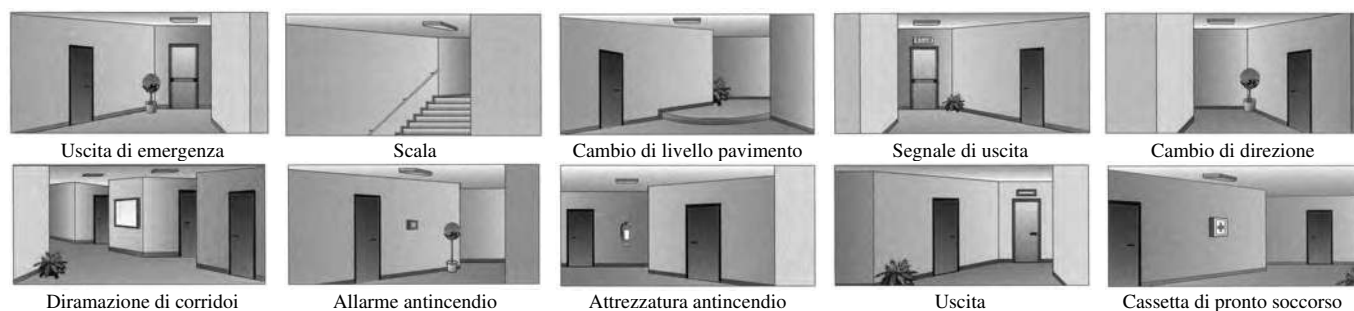
Fig. 2.169 - Esempi di applicazione delle apparecchiature di illuminazione di emergenza e segnaletica.
