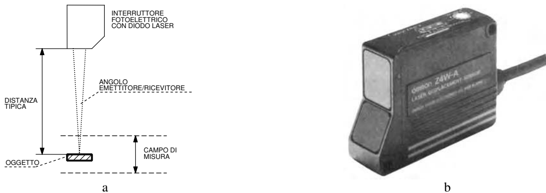
Fig. 6.207 - a) Principio di funzionamento di un interruttore fotoelettrico con diodo laser - b) Sensore di spostamento laser Z4W-A29 (Omron).
