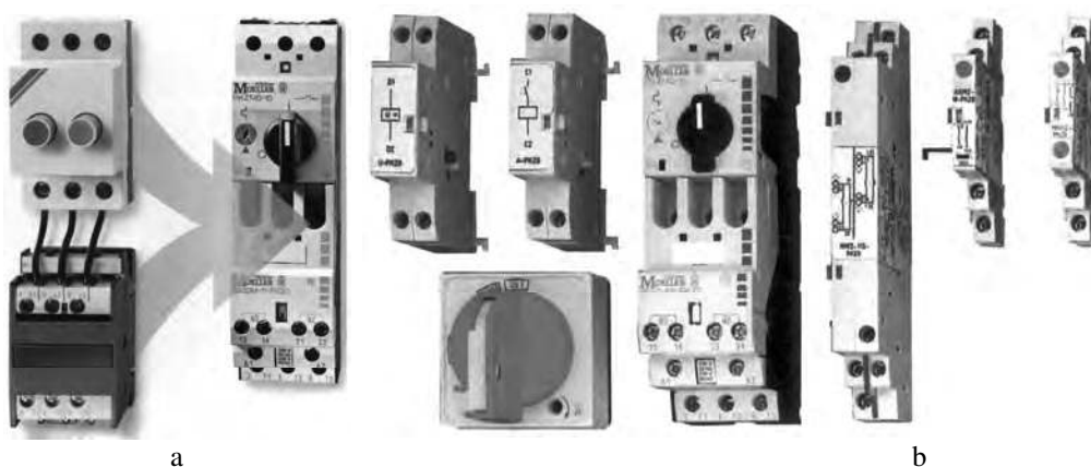
Fig. 6.3 - Sistema di protezione PKZ 0: a) In un unico apparecchio è possibile comandare e proteggere motori fino a 4 kW/400 V, sganciatore magnetico fisso a 14 I_n , protezione contro il sovraccarico da 0,6 I_n a 1 I_n , sensibile alla mancanza di fase - b) Esempio di possibile configurazione (Klökner-Moeller).
