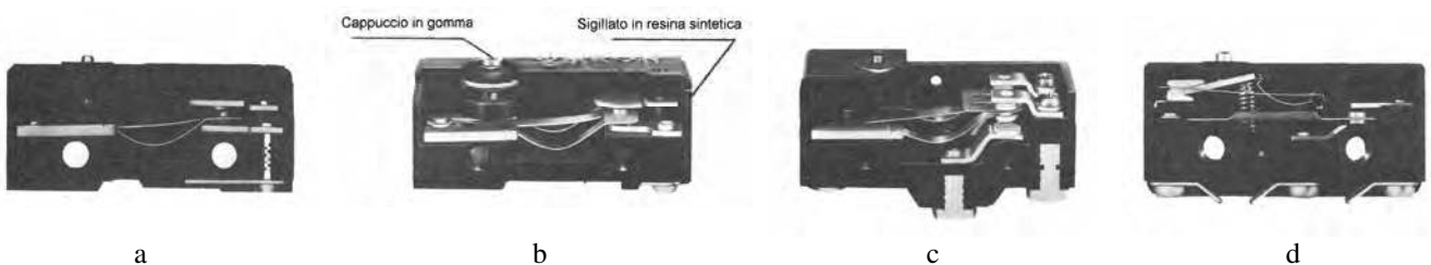
Fig. 6.109 - Particolari costruttivi di microinterruttori: a) Tipo base - b) Tipo sigillato - c) Tipo a contatti sdoppiati - d) Tipo Bipolare (Omron).
