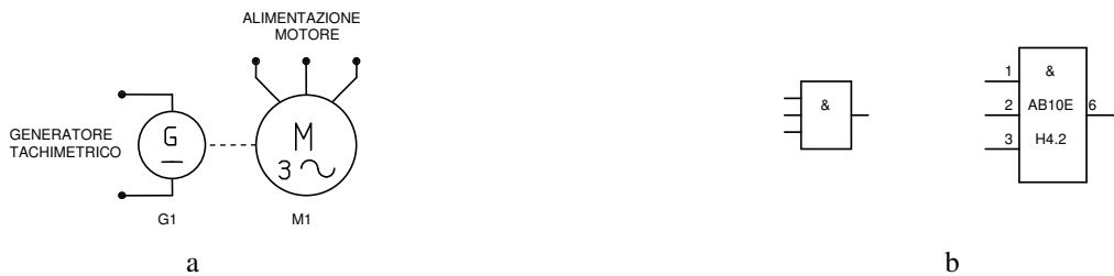
Fig. 1.10 - Esempi di segni grafici di diverse dimensioni per rappresentare: a) Macchine elettriche con caratteristiche particolari (motore asincrono con relativo generatore tachimetrico) - b) L'inclusione di certe particolarità in un elemento logico binario.
