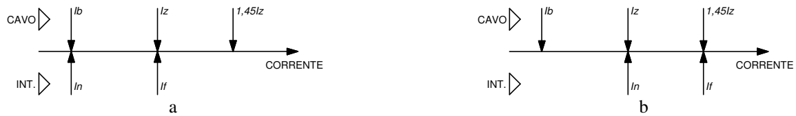
Fig. 2.47 - Condizioni limite di una conduttura contro il sovraccarico: a) Massima protezione - b) Minima protezione.
