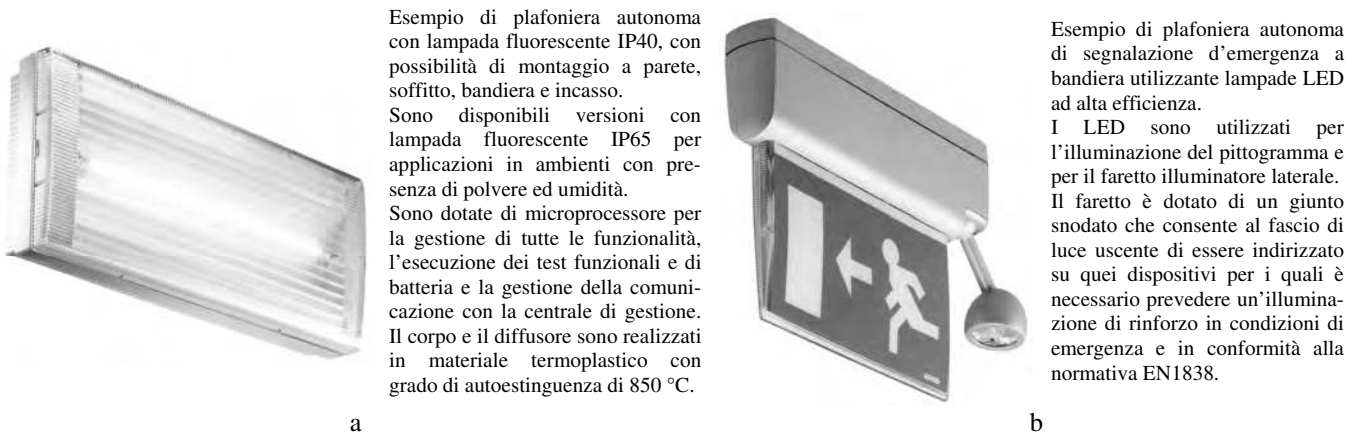
Fig. 2.167 - a) Plafoniera autonoma con lampada fluorescente - b) Plafoniera autonoma con lampada a LED del tipo a bandiera completa di faretto illuminatore aggiuntivo orientabile. Questo apparecchio consente contemporaneamente due funzioni: segnalazione ed illuminazione di emergenza (Gewiss).
