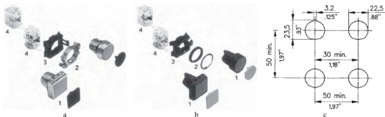
Fig. 6.70 - Istruzioni per il montaggio di pulsanti di serie rotonda e quadrata \varnothing 22 mm, per spessori di pannello da 1 a 6 mm: a) Corpo operatore in metallo - b) Corpo operatore in termoplastico (BRETER) - c) Dimensioni minime, in millimetri e pollici.
