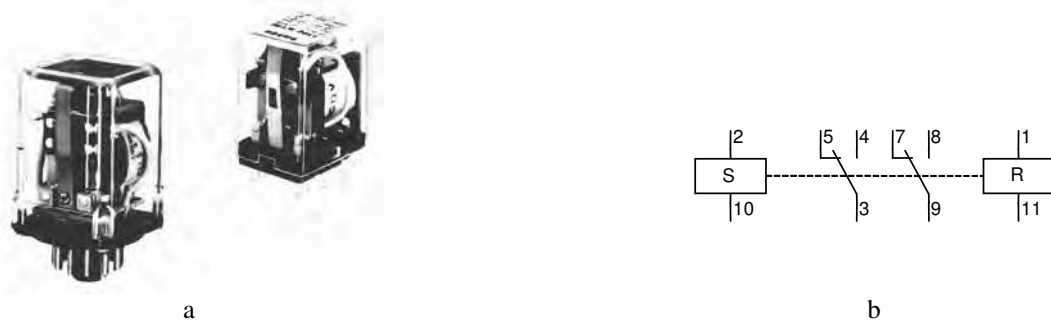
Fig. 2.123 - Esempio di relè bistabile tipo MK2K e MYK: a) Modelli disponibili - b) Collegamenti. Questi relè, del tipo a ritenuta magnetica o meccanica, sono disponibili con i terminali ad innesto e per circuito stampato (MYK), con 2 contatti in deviazione e con indicatore meccanico di stato. Sono disponibili modelli con bobina funzionante in AC (6÷230 V) o DC (6÷110 V). La corrente massima di passaggio è di 5 A, mentre la tensione massima di funzionamento è di 440 V AC e 250 V DC (Omron).
