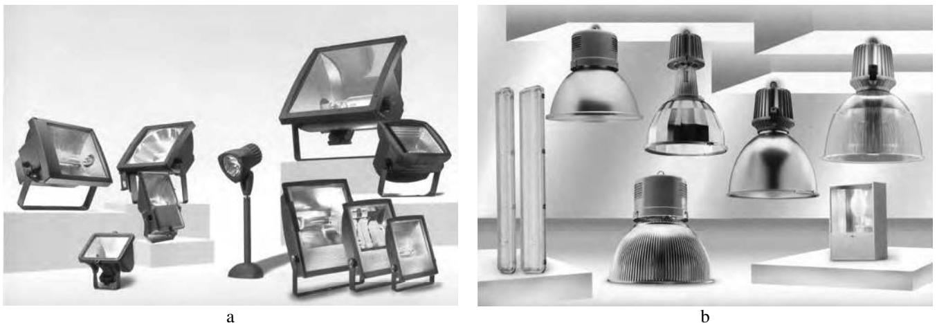
Fig. 3.51 - Apparecchi di illuminazione per interni ed esterni: a) Esempi di proiettori funzionanti a 220÷230 V per lampade fluorescenti (da 2x18 W a 1x120 W), alogene (da 50 W a 1500 W) e a scarica (da 35 W a 2000 W) - b) Esempi di plafoniere stagne per lampade fluorescenti tubolari, compatte e compatte ad alimentazione elettronica (da 1x18 W a 4x55 W) e riflettori per lampade a scarica (da 125 W a 400 W) tutti funzionanti a 220÷230 V (Gewiss).
