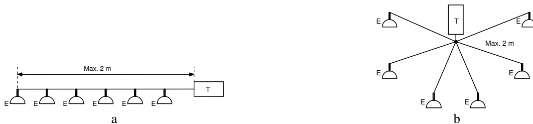
Fig. 2.146 - Collegamento tra il trasformatore elettronico (T) e gli apparecchi di illuminazione (E): a) - La lunghezza massima della linea a 12 V deve essere inferiore a 2 m - b) L'installazione è possibile entro un'area circolare di 4 m (Relco).
