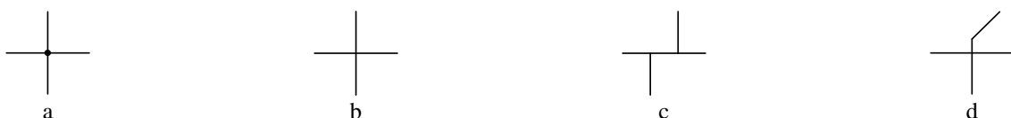
Fig. 1.39 - Esempi di incroci e derivazioni: a) Incrocio con collegamento - b) Incrocio senza collegamento - c) Derivazioni - d) Incrocio con cambiamento di direzione (senza collegamento).
