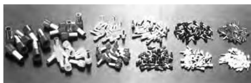
Fig. 6.344 - Terminali a tubetto con collare isolato: a) Esempi di tubetti in rame elettrolitico stagnato con l'isolante in polipropilene - b) Codice dei colori per l'identificazione secondo le norme DIN 46288/4 (Cabur).
