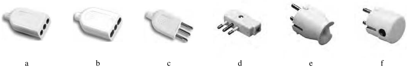
Fig. 2.112 - Esempi di prese mobili: a) Presa mobile, standard italiano 10 A, 250 V - b) Presa mobile bivalente, standard italiano 10/16 A, 250 V - Esempi di spine: c) Spina diritta standard italiano 10 A, 250 V - d) Spina a 90° standard italiano - e) Spina diritta standard tedesco/UNEL/francese con doppio contatto di terra: laterale tipo UNEL e mediano standard francese - f) Spina a 90° standard tedesco/UNEL/francese con doppio contatto di terra: laterale tipo UNEL e mediano standard francese.
