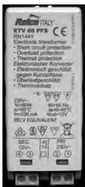
Fig. 2.145 - Trasformatore elettronico per lampade alogene a bassissima tensione: - a) Esempio di caratteristiche tecniche - b) Scheda elettronica. Da notare, sulla sinistra i morsetti di alimentazione a 230 V, mentre sulla destra i morsetti di uscita a 12 V da collegare alle lampade alogene a bassissima tensione, nonché il trasformatore, realizzato con nucleo di ferrite, che consente di ottenere un’alimentazione di sicurezza di tipo SELV (Relco).
