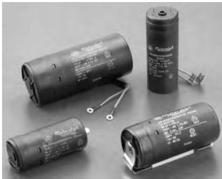
Fig. 7.49 - a) Esempi di condensatori di avviamento elettrolitici per motori monofase. Custodie stampate in materiale termoplastico autoestinguente, terminali del tipo a saldare e a innesto tipo Faston 6,3 mm doppi (Ducati energia) - b) Curve caratteristiche della coppia in funzione della velocità di un motore monofase con o senza dispositivo di avviamento ( n_0 : velocità di sincronismo, n_N : velocità nominale) (La-fert).
