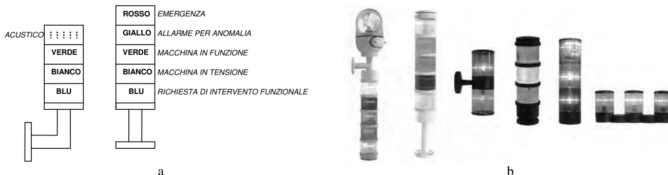
Fig. 6.84 - a) Esempio di codifica cromatica di una torretta con montaggio mediante snodo a 90° con 3 possibili messaggi luminosi e segnalazione acustica; esempio di torretta con 5 possibili messaggi luminosi - b) Esempi di torrette luminose componibili in varie configurazioni (Sirena).
