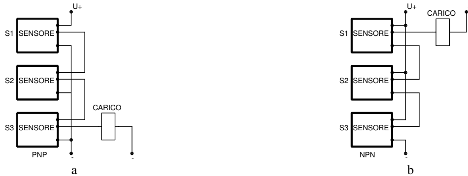
Fig. 6.131 - Collegamento in serie di interruttori di prossimità con uscita allo stato solido: a) Tipo PNP - b) Tipo NPN.
