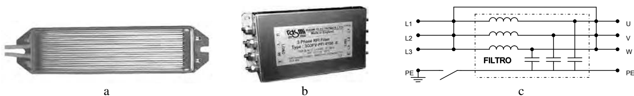
Fig. 7.93 - a) Esempio di resistore (resistenza) di frenatura - b) Esempio di filtro di rete trifase - c) Prima di effettuare la misura della resistenza di isolamento, occorre cortocircuitare e disinserire eventuali filtri.
