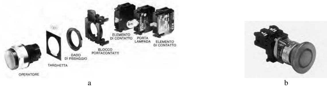
Fig. 6.77 - a) Esemplio di pulsante luminoso con due elementi di contatto e portalampada (anche a LED) - b) Esemplio di pulsante luminoso a fungo assiale.
