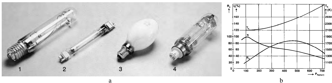
Fig. 3.36 - a) Lampade a vapori di sodio: 1) Tipo ad alta pressione standard tubolare in vetro chiaro, 2) Tipo ad alta pressione standard tubolare con attacchi laterali, 3) Tipo ad alta pressione standard con bulbo diffondente ellissoidale, 4) Tipo a bassa pressione tubolare in vetro chiaro (Osram) - b) Variazione dell'indice di resa cromatica ( R_a ), efficienza luminosa ( \eta ) e temperatura di colore ( T_K ), in funzione dell'aumento della pressione del vapore di sodio all'interno del tubo di scarica nelle lampade ad alta pressione (1 torr equivale a 133,32 Pa).
