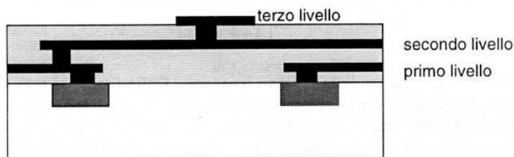
Figura 2.7 Metallizzazioni e interconnessioni a più livelli
