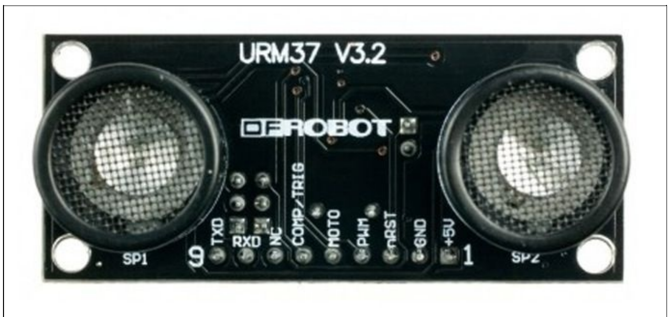
Figura 3.10 Sensore a ultrasuoni URM37 prodotto da DFrobot.
