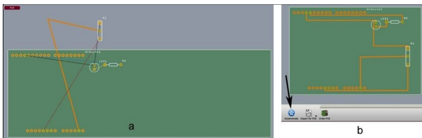
Figura 4.14 (a) Vista PCB del progetto Potenziometro visibilmente disordinato e (b) successivamente autoinstradato.
