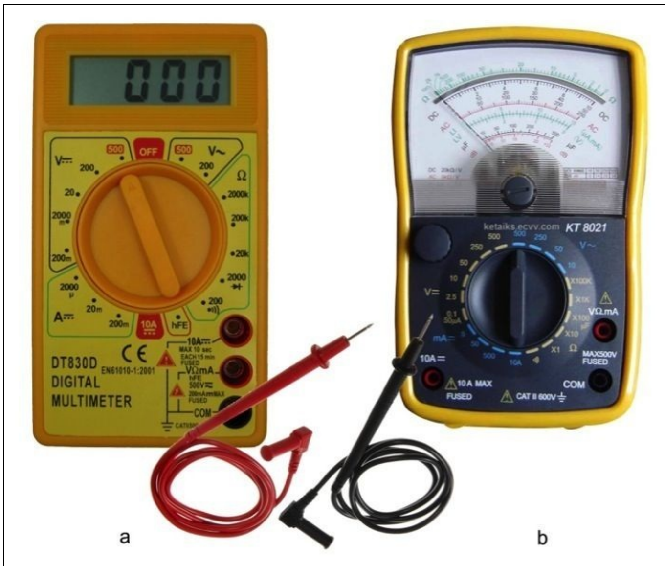
Figura 1.20 (a) Multimetro digitale. (b) Multimetro analogico.
