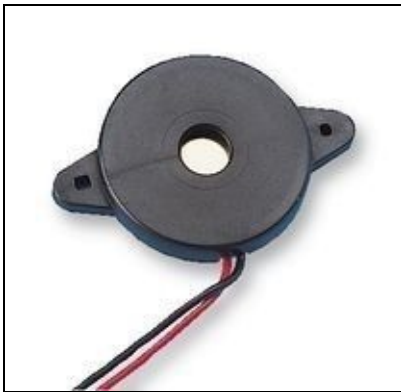
Figura 3.9 Un tipico trasduttore piezoelettrico.
