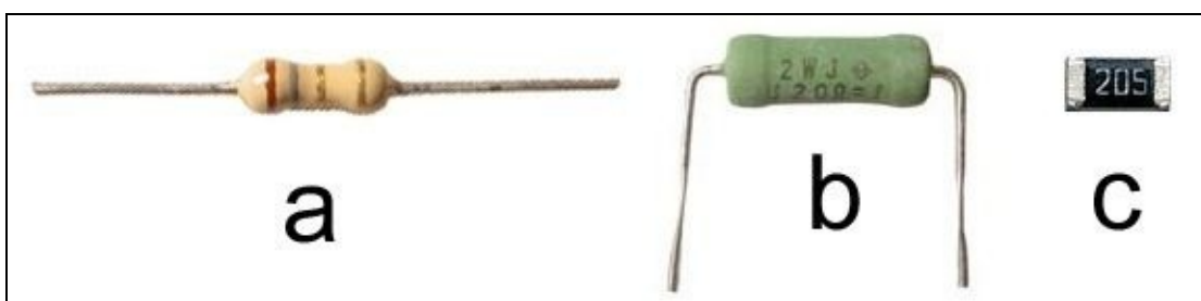
Figura 2.10 A sinistra, un comune resistore fisso. Il valore in \Omega è riportato secondo un codice colori. Al centro, un resistore di potenza con il valore stampigliato per esteso. A destra, un resistore SMD ingrandito.
