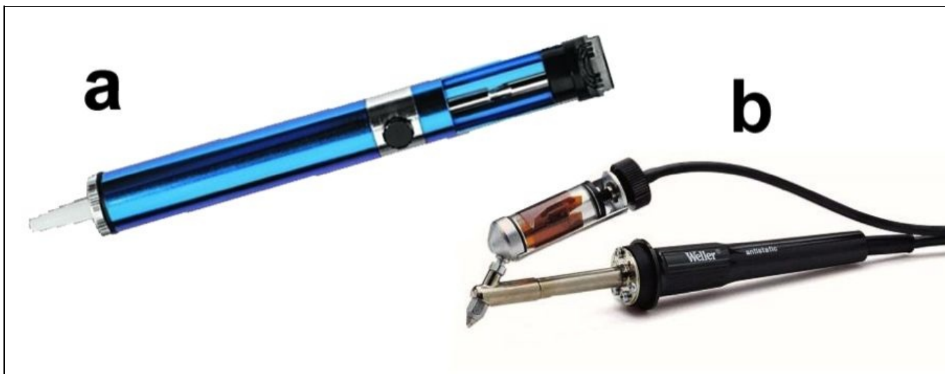
Figura 1.17 (a) Un economico “aspira-stagno” a molla. (b) Un dissaldatore professionale.
