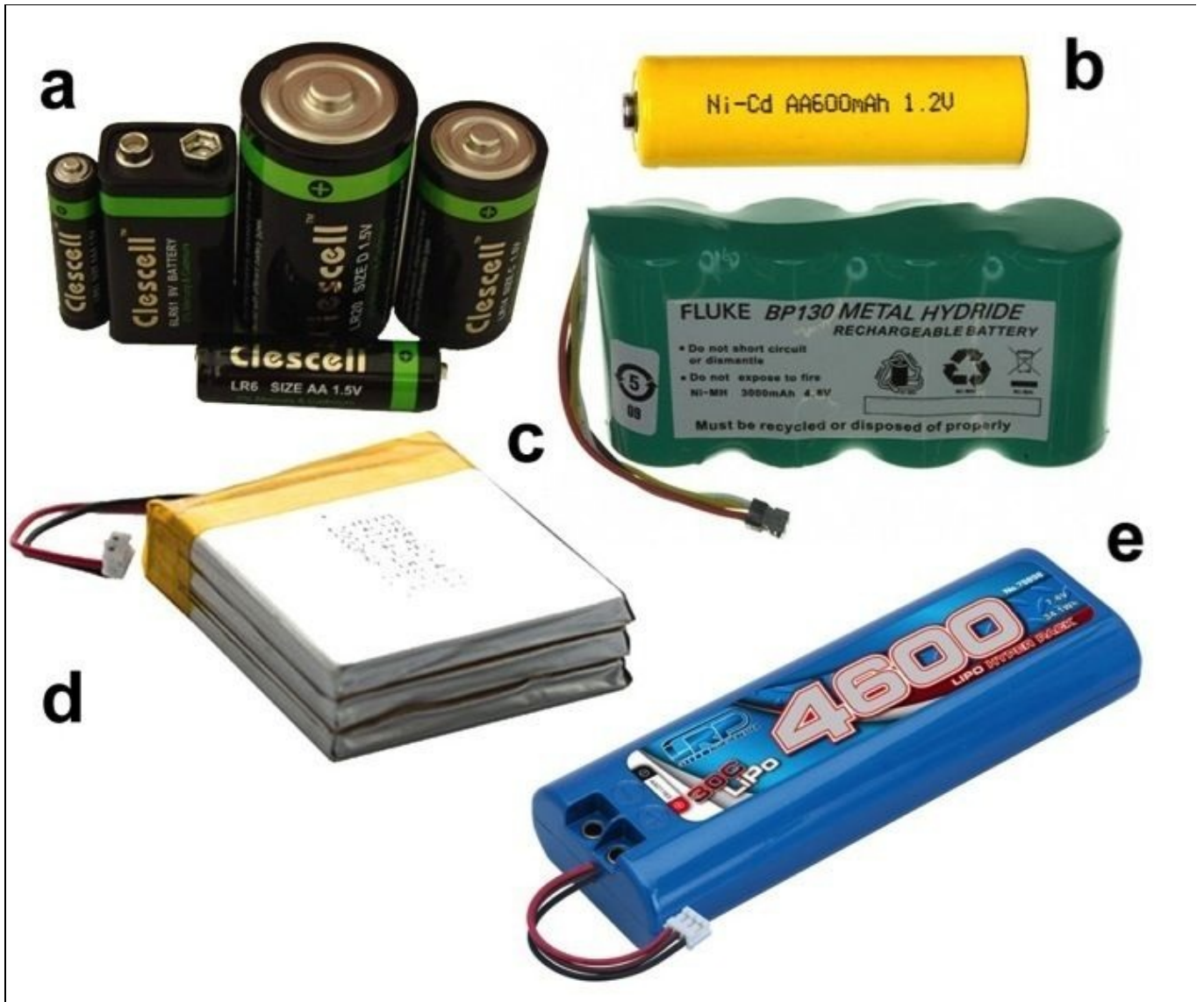
Figura 5.1 (a) Vari tipi di pile alcaline. (b) Accumulatori ricaricabili al nichel-cadmio e nichel-metallo idruro. (c) Gli accumulatori sono disponibili anche in pacchetto per fornire tensioni particolari. (d) Accumulatori ricaricabili agli ioni di litio. (e) Accumulatori ricaricabili al litio-polimero.
