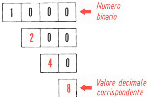
Fig. 1.10 - Rappresentazione delle fasi che consentono di ottenere il valore decimale 8, dal corrispondente numero in forma binaria.
