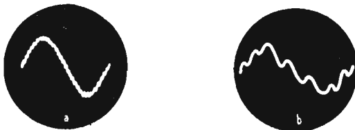
FIG. 58. - a) Sinusoide deformata. b) Sinusoide di 50 Hz modulata a 400 Hz.
