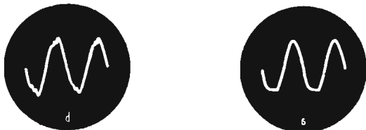
Fig. 60. - Distorsione dovuta ad un sovraccarico (a) e ad una reazione combinata con un sovraccarico (b).
