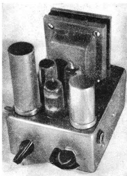
FIG. 84. - Insieme dell'amplificatore miniatura. Il telaio misura solo 10 × 12 × 5 cm.
