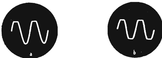
FIG. 59. - Distorsioni tipiche. Il segnale a è livellato alla sommità ed il segnale b alle due estremità.
