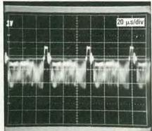
FIG. 16—INVERTED VIDEO AT IC1, pin 6.
