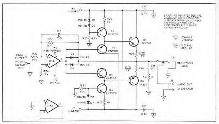
Fig 3—The SuperSCAF audio-amplifier schematic diagram. D1-D6, incl—1N4148 silicon diode. J2—Phono Jack. Q1, Q2—2N3906. Q1, Q2—2N3906.
