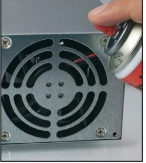
Per evitare che si accumuli polvere nell'alimentatore, possiamo soffiare con una bomboletta ad aria compressa attraverso le griglie di areazione, in particolare vicino al punto di rotazione della ventola. Col beccuccio della bomboletta possiamo arrivare facilmente anche ai componenti interni. Prima di compiere questa operazione, non dimentichiamo di staccare il cavo dell'alimentatore dalla presa.
