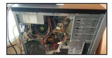
Rimuoviamo le viti di blocco, scolleghiamo i cavi di alimentazione, il connettore e delicatamente sfiliamo il disco. A volte, per estrarlo occorre rimuovere solo una delle due paratie laterali.
