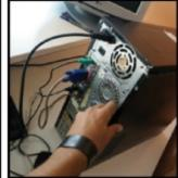
Per i computer "fissi" dobbiamo mettere mano all'interno del case. Pertanto, stacchiamo i cavi di alimentazione e anche quelli di collegamento alle periferiche. Rimuoviamo le paratie laterali svitando le viti poste sul lato posteriore del case.
