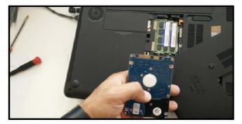
Osservando la forma dei connettori possiamocapire quale tipo di collegamento supporta il nostro computer. Per un ulteriore conferma, possiamo controllare sull'etichetta del disco la presenza della sigla IDE o SATA.
