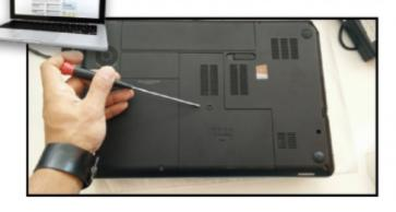
L'hard disk di un portatile è quasi sempre raggiungibile in maniera abbastanza semplice. Generalmente è posizionato nella parte inferiore del case: basta dunque rimuovere le viti di fissaggio per raggiungere il vano porta disco.
