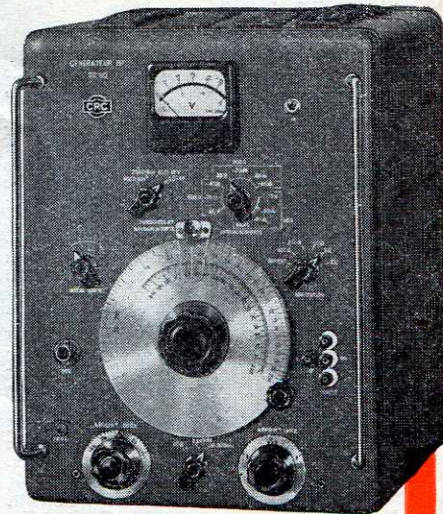
Le générateur interférentiel GB 110 de C.R.C. a deux gammes : 20 Hz à 20 kHz, modulables en fréquence de l'extérieur, et 20 à 200 kHz.
