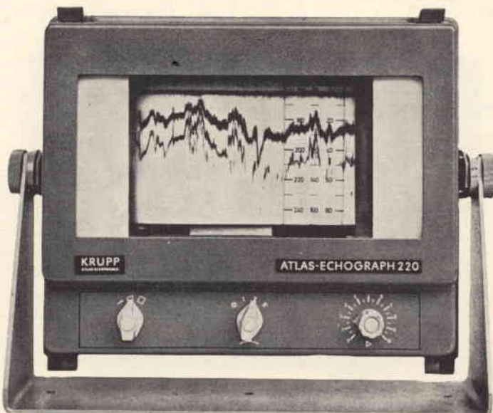
Fig. 8 - Scandaglio ultrasonoro della ATLAS-ECHOGRAPH 220 con indicazione visiva delle misure. E' adatto per la pesca e l'individuazione degli ostacoli.
