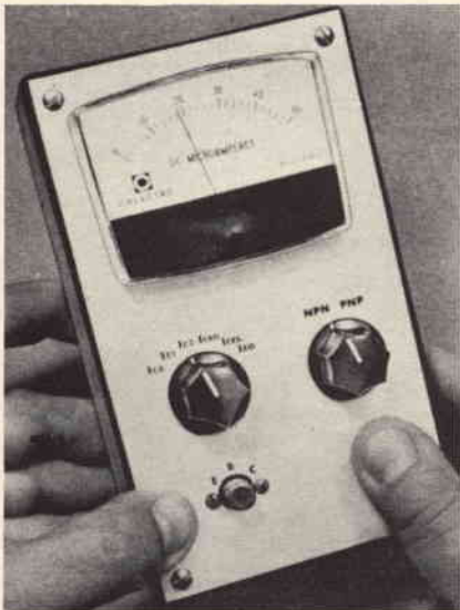
Fig. 16 - Aspetto del prova-transistori di tipo non distruttivo, a realizzazione ultimata.
