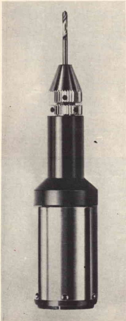
Fig. 7 - Trapano elettrico in grandezza naturale realizzato mediante il micromotore illustrato in fig. 6.
