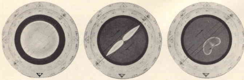
Fig. 7 - Tubo indicatore del radiogoniometro Kodon KS-321UA con indicazione di due rilevamenti (l'incertezza di 180° del rilevamento centrale è eliminata nel rilevamento di destra).
