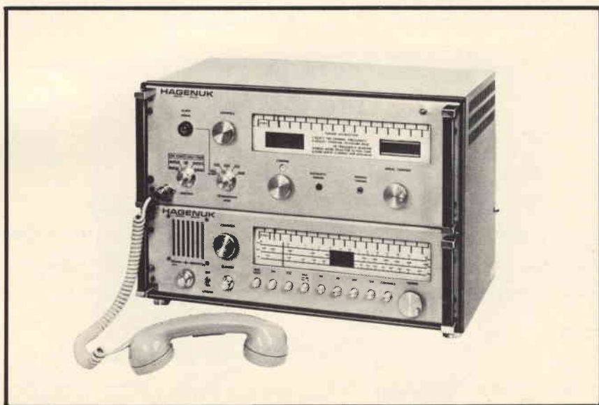
Fig. 1 - Radiotelefono per la gamma 1600 ÷ 4200 kHz - EGT 200 - SSB Potenza di uscita 200 W PEP. Alimentazione in corrente continua. Ricezione gamma dei radiofari e delle stazioni di radiodiffusione.
