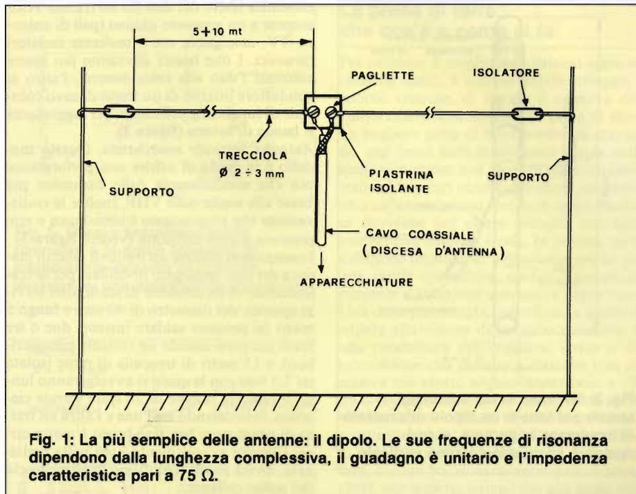
**Fig. 1: La più semplice delle antenne: il dipolo. Le sue frequenze di risonanza dipendono dalla lunghezza complessiva, il guadagno è unitario e l'impedenza caratteristica pari a 75  $\Omega$ .**
