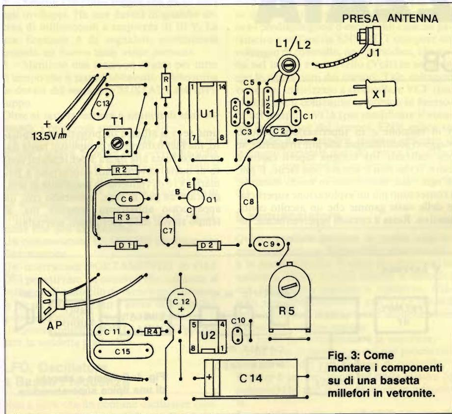
Fig. 3: Come montare i componenti su di una basetta millefori in vetronite.
