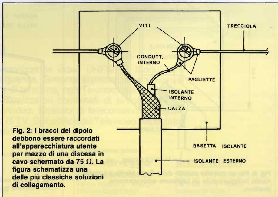
**Fig. 2: I bracci del dipolo debbono essere raccordati all'apparecchiatura utente per mezzo di una discesa in cavo schermato da 75  $\Omega$ . La figura schematizza una delle più classiche soluzioni di collegamento.**
