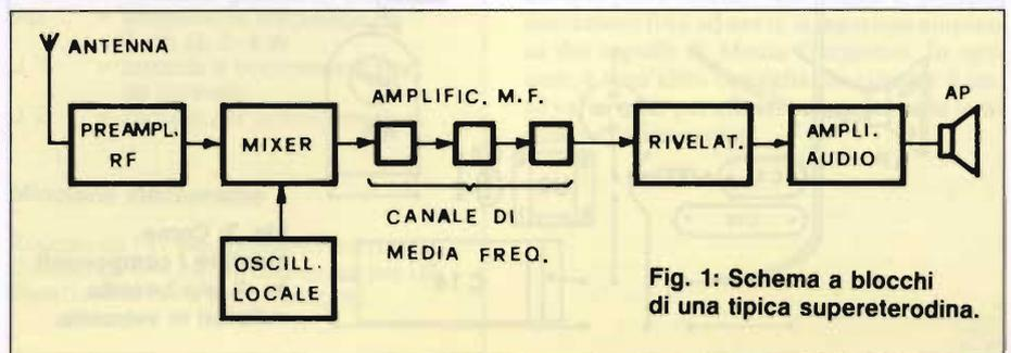
Fig. 1: Schema a blocchi di una tipica supereterodina.
