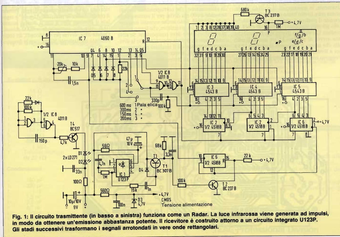
Fig. 1: Il circuito trasmettente (in basso a sinistra) funziona come un Radar. La luce infrarossa viene generata ad impulsi, in modo da ottenere un'emissione abbastanza potente. Il ricevitore è costruito attorno a un circuito integrato U123P. Gli stadi successivi trasformano i segnali arrotondati in vere onde rettangolari.
