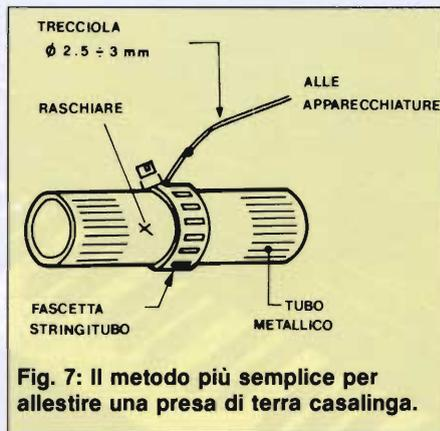
**Fig. 7:** Il metodo più semplice per allestire una presa di terra casalinga.
