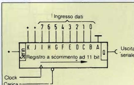
Fig. 1. Schema di conversione da parallelo a seriale.
