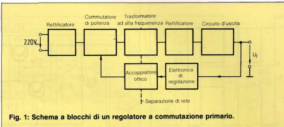
Fig. 1: Schema a blocchi di un regolatore a commutazione primario.
