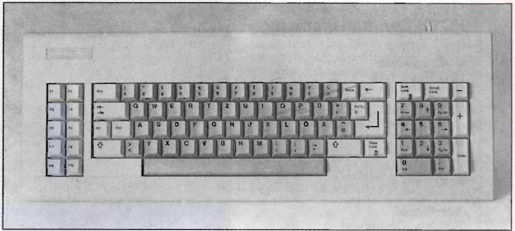
**Vista della tastiera estremamente simile a quella del PC dell'IBM. Il confronto con la tastiera dell'M24 (identica a quella dell'IBM PC), mette in evidenza quelli che sono i cambiamenti apportati, in realtà lievi, ma significativi.**
