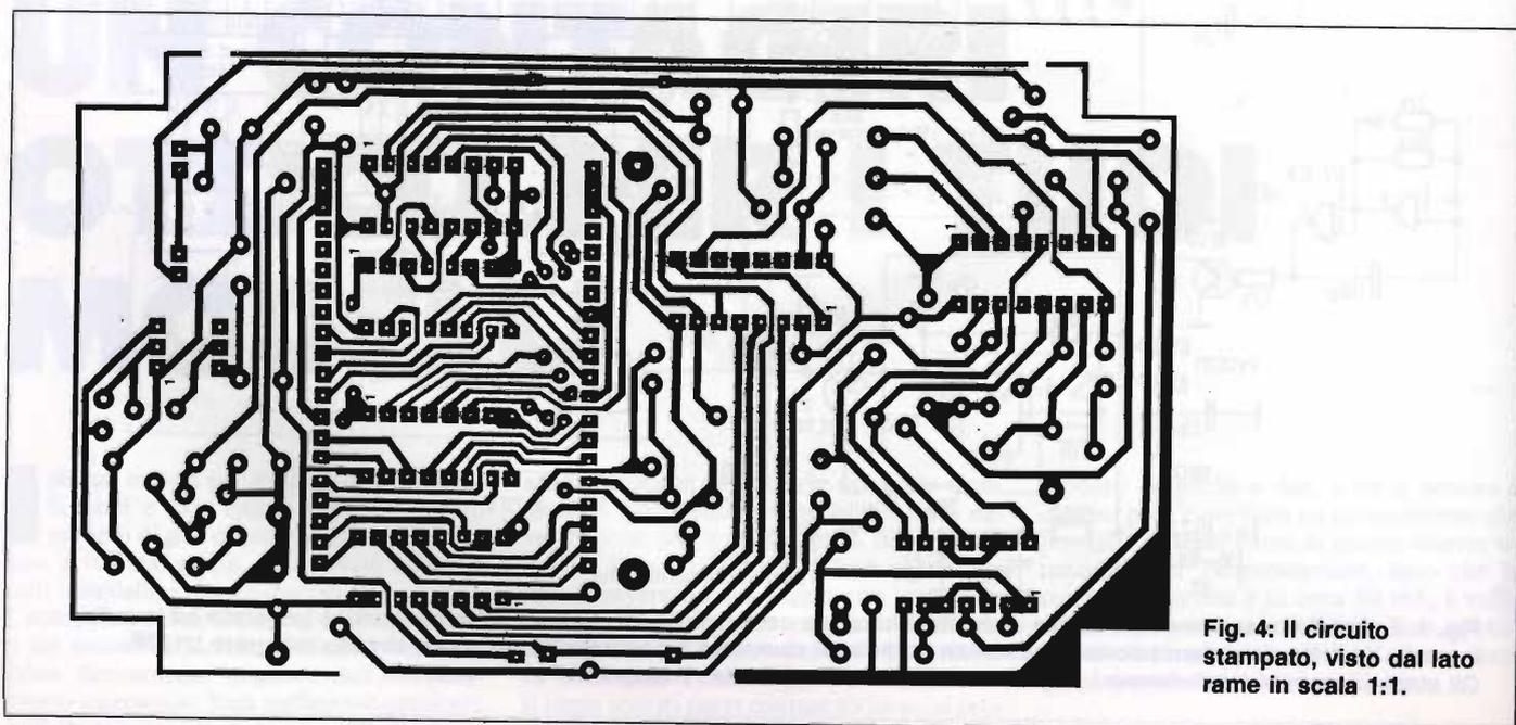
Fig. 4: Il circuito stampato, visto dal lato rame in scala 1:1.
