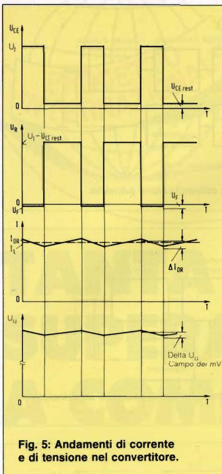
Fig. 5: Andamenti di corrente e di tensione nel convertitore.
