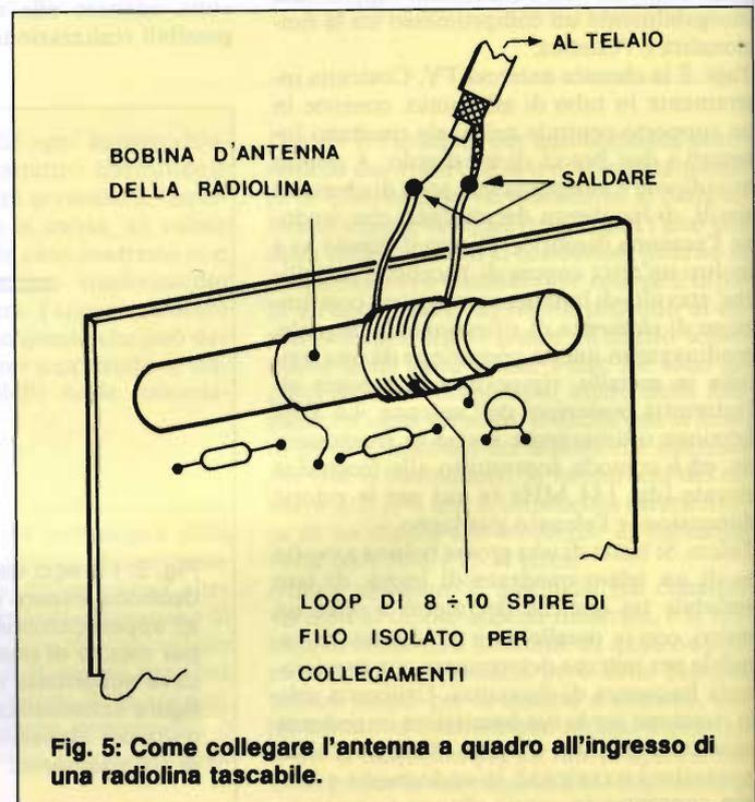
**Fig. 5: Come collegare l'antenna a quadro all'ingresso di una radiolina tascabile.**
