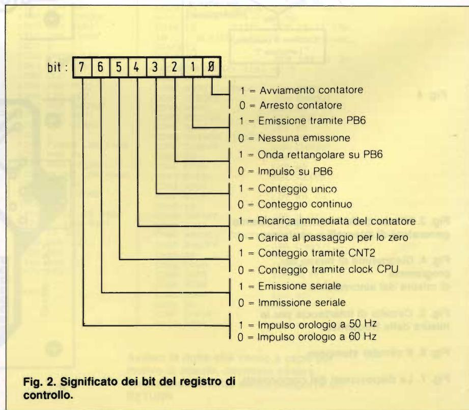
Fig. 2. Significato dei bit del registro di controllo.
