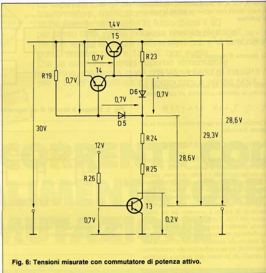
Fig. 6: Tensioni misurate con commutatore di potenza attivo.
