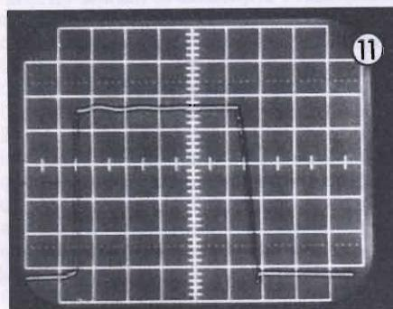
Fig. 11:  $U_u = 5$  V,  $I_u = 2,5$  A. Osservare bene come avviene la variazione del rapporto impulso/pausa, all'emettitore di T5.
