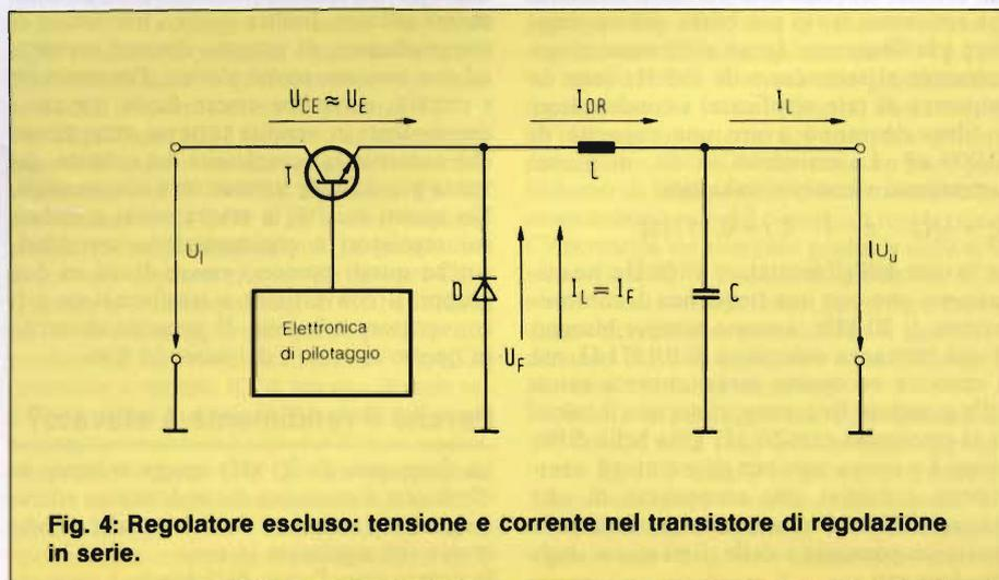
Fig. 4: Regolatore escluso: tensione e corrente nel transistorore di regolazione in serie.
