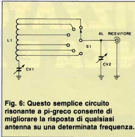
**Fig. 6:** Questo semplice circuito risonante a pi-greco consente di migliorare la risposta di qualsiasi antenna su una determinata frequenza.
