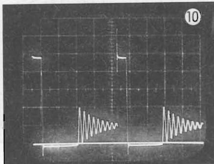
Fig. 10:  $U_u = 5$  V, con carico non collegato all'emettitore di T5; X = 10 micros/cm, Y = 1 Vp-p/cm.
