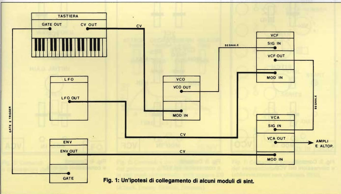
Fig. 1: Un'ipotesi di collegamento di alcuni moduli di sint.
