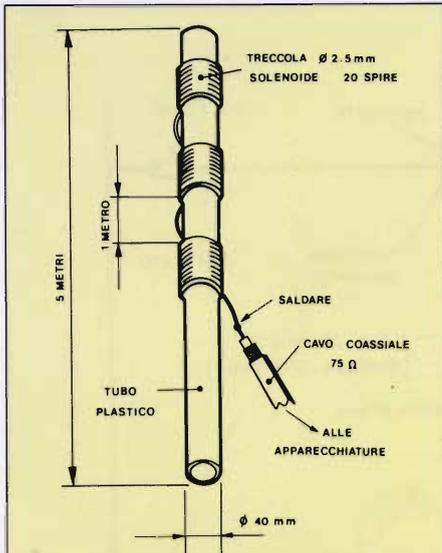
**Fig. 3: Nel caso in cui scarseggi lo spazio per tenere un dipolo orizzontale di lunghezza opportuna, si può ripiegare su questa antenna verticale.**
