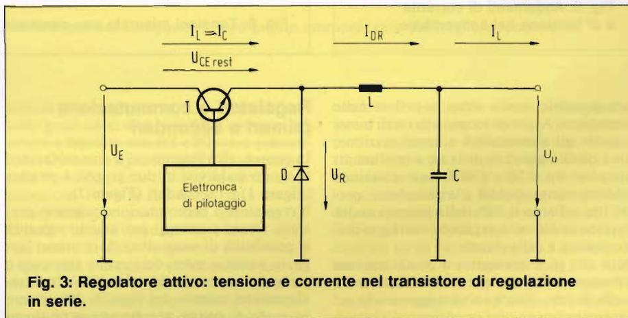
Fig. 3: Regolatore attivo: tensione e corrente nel transistorore di regolazione in serie.
