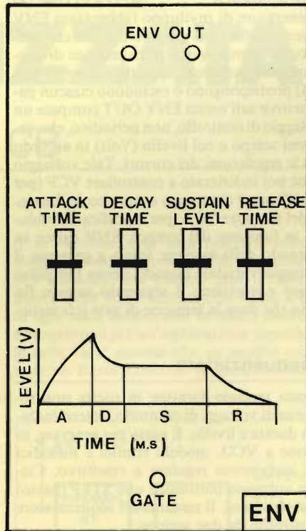
Fig. 6: Comandi e connessioni del generatore di involuppo, in vari modi abbreviato: ENV oppure EG (Envelope Generator) oppure ADSR (Attack, Decay, Sustain, Release).
