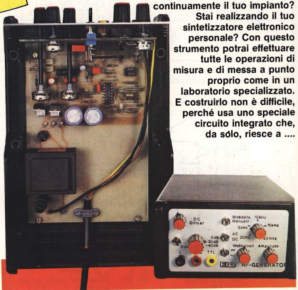
Il generatore volutato di bassa frequenza, con il suo trasformatore di alimentazione: sono visibili i due regolatori di tensione integrati.
