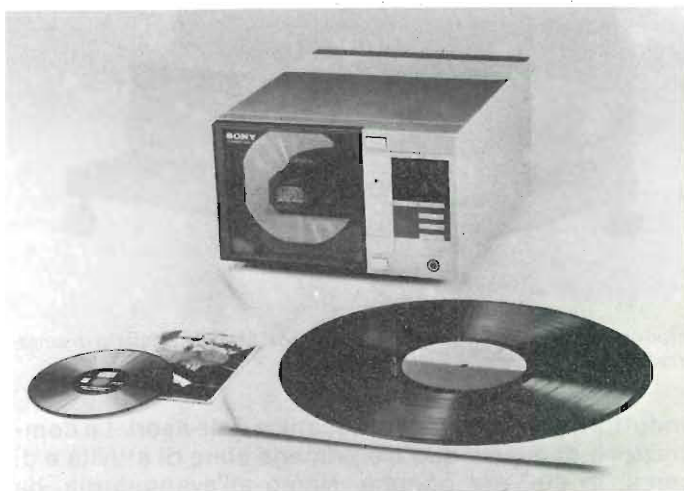
Il "Compact disc" Sony confrontato con un normale disco a 33 giri. Il "Compact disc" ha un diametro di 12 cm. ed una durata di ascolto di 60 minuti.
