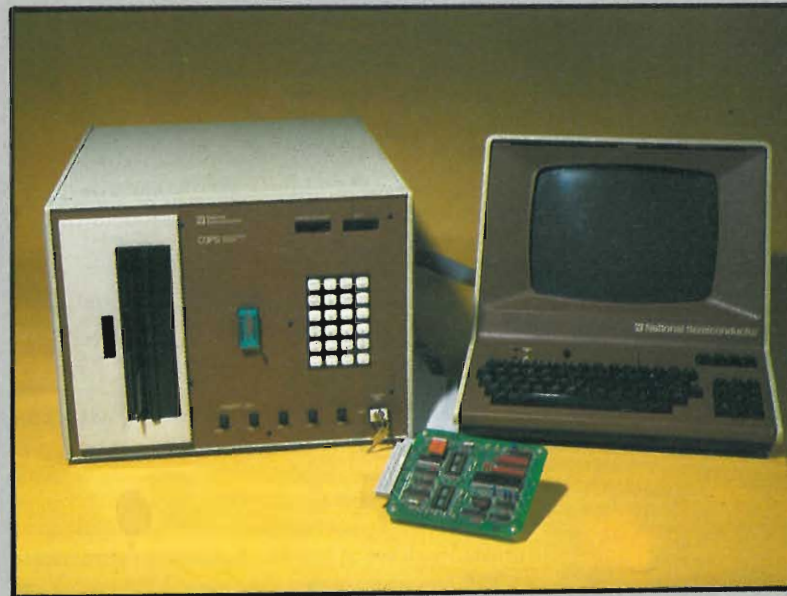
Sistema di sviluppo per i COPS, utilizzato per la realizzazione del software ed il collaudo dell'hardware.
