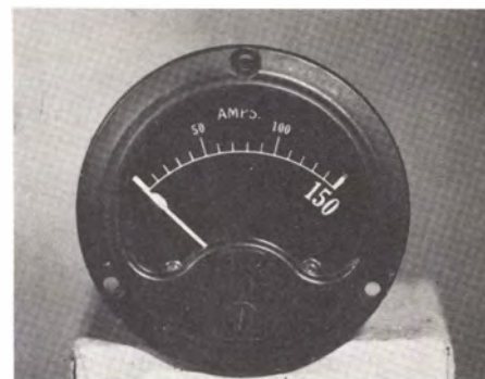
Fig. 11 - Finto amperometro in cui l'indicazione riportata è raggiunta mediante una Shunt formato da una barretta di nichel-cromo.
