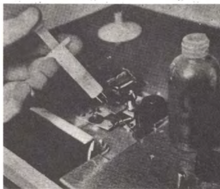
Fig. 14 - Siringa per iniezioni usata per oliare punti inaccessibili in apparecchi miniaturizzati.
