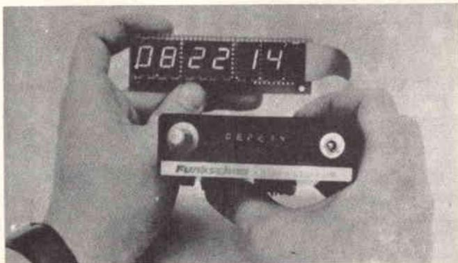
*Fig. 1 - All'orologio nella cassa miniaturizzata può essere collegato direttamente un altro visualizzatore.*
