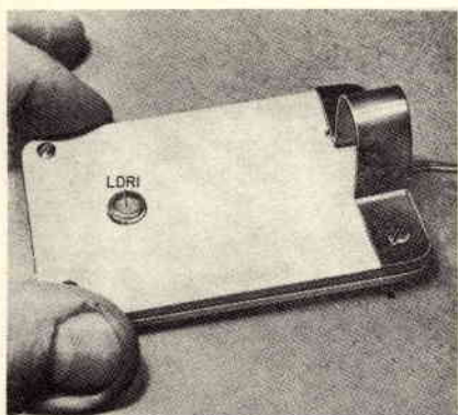
Fig. 2 - Metodo di allestimento del supporto della fotocellula, costituito da una basetta di materiale isolante munita di un'impugnatura in piattina di alluminio, che ne consente lo spostamento. La parte inferiore di questo supporto deve essere di natura tale da evitare di graffiare la carta fotografica sulla quale viene appoggiata.
