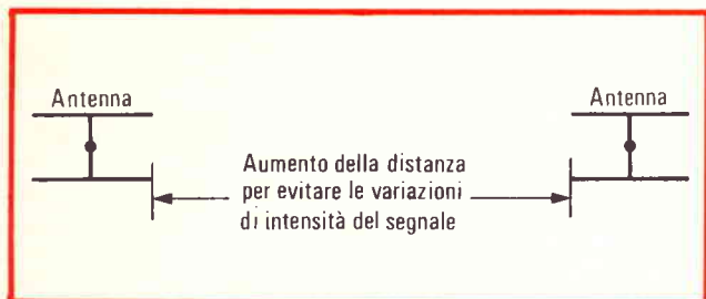
Fig. 3 - I segnali TV sono soggetti ad improvvise variazioni di intensità, e sono disturbati dal volo degli aeroplani. L'aumento della distanza fra le antenne può migliorare la ricezione televisiva.
