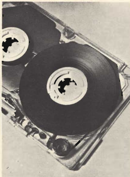
Fig. 8 - La fotografia mette in evidenza uno dei metodi di più frequente impiego, adottato per facilitare l'inserimento della cartuccia sui due alberi della parte meccanica, di cui uno per azionare la bobina raccoglitrice, ed una per il riavvolgimento su quella detta fornitrice.
