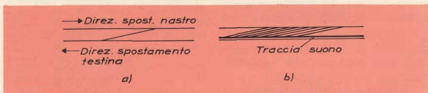
Fig. 7 - A) rappresenta un'unica traccia video registrata sul nastro. B) illustra invece diverse tracce video adiacenti, unitamente alla traccia relativa al suono.
