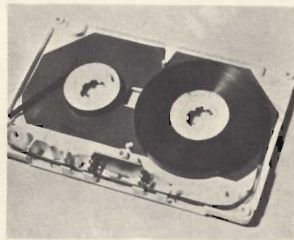
Fig. 2 - Altro esempio di cartuccia aperta, che viene qui illustrata per fornire un esempio di uniforme e regolare avvolgimento del nastro sia sulla bobina raccogli-trice, sia su quella fornitrice.
