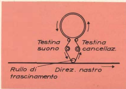
Fig. 9 - Rappresentazione schematica del percorso del nastro intorno al tamburo, secondo il sistema « \alpha » (alfa).
