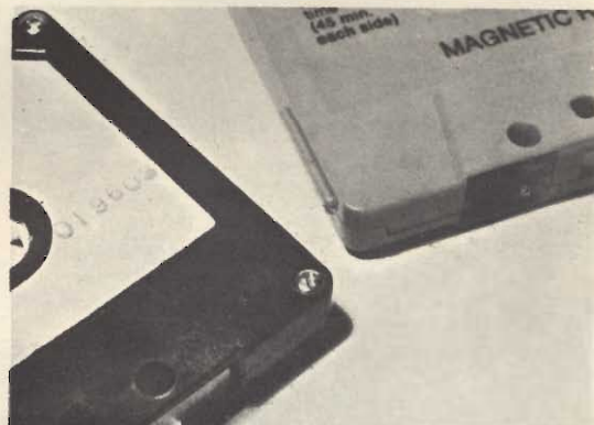
Fig. 9 - Due diversi metodi per chiudere una cartuccia di nastro: a sinistra è illustrato il metodo basato sull'impiego di viti autofilettanti nei quattro angoli, ed a destra è visibile un particolare di una cartuccia nella quale le due metà dell'involucro esterno sono saldate tra loro.
