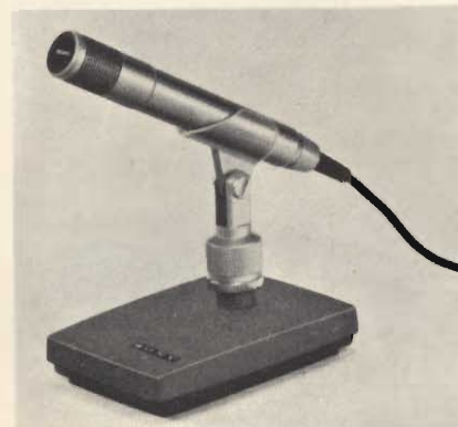
Fig. 7 - Microfono omnidirezionale «Electret Condenser» SONY ECM-52 - Risposta di frequenza: 40 \div 16.000 Hz. Impedenza d'uscita: 50-250-600 \Omega \pm 20\% a 1000 Hz - Alimentazione: 1,5 V.
