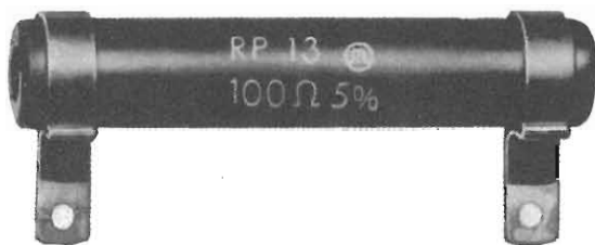
Fig. 4 - Resistore a filo per potenze elevate.
