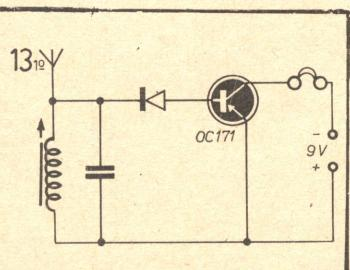
disegnato un NPN: se si usa un PNP invertire la pila.
