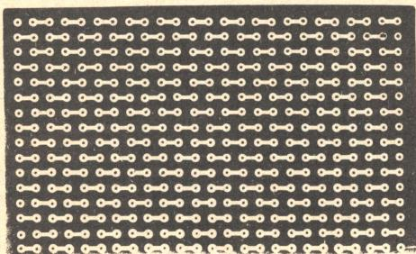
Piastra a foratura modulare per montaggi sperimentali, in laminato fenolico XXXPC-rame, con circuito stampato.
