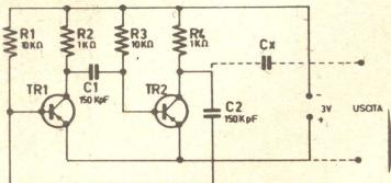
**MULTIVIBRATORE:** Un piccolo generatore di segnali completo di ogni accessorio e transistors.
