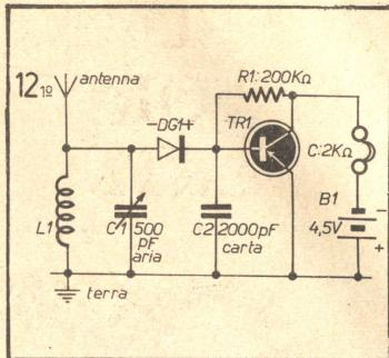
**Il circuito è abbastanza semplice. Pregevole è la configurazione a reflex che consente la doppia amplificazione in A.F. e B.F. La sintonia risente però della possibile diversa lunghezza della antenna.**
