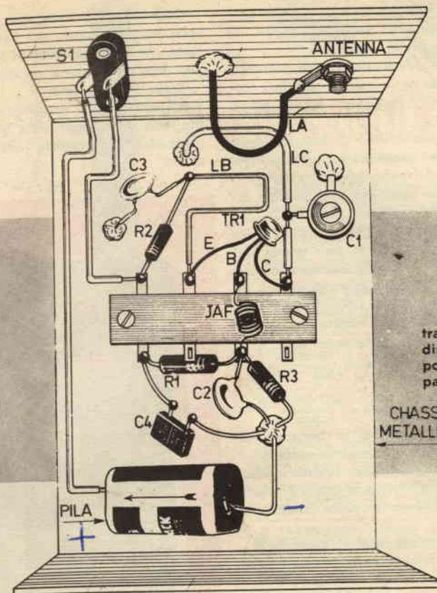
Schema pratico del trasmettitore; le parti disegnate rispettano la posizione di quelle appartenenti al prototipo.
