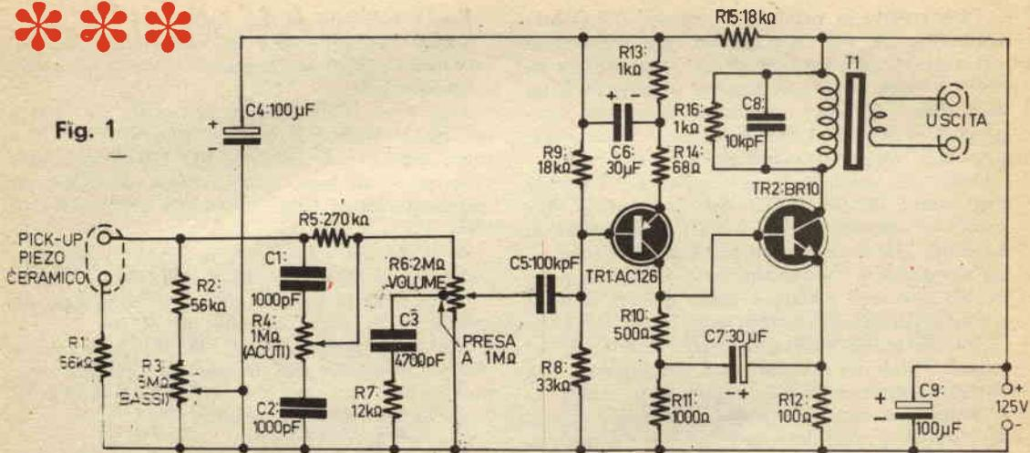
**Fig. 1 :** Schema elettrico dell'amplificatore.
