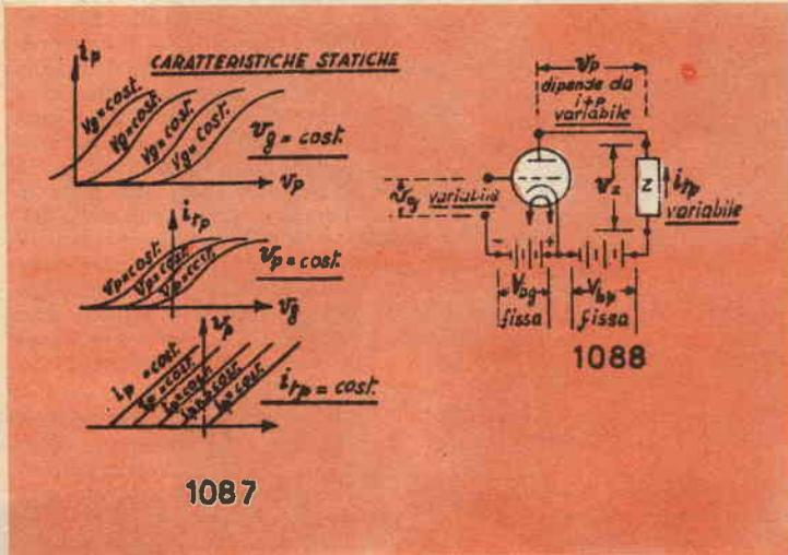
come si corrispondono la corrente di placca, la tensione di placca e la tensione di griglia, e sono valide quando si immagini costante una delle predette grandezze e variabili solo le altre due, quindi in condizioni particolari e non in condizioni di movimento (cioè funzionamento) del tubo, e pertanto sono dette **caratteristiche statiche**.
