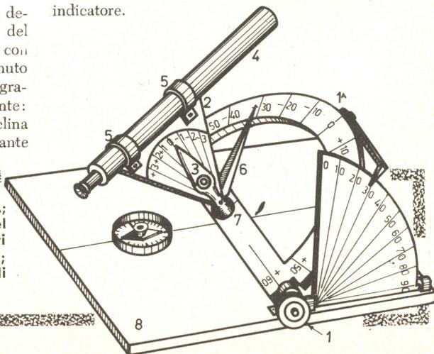
Fig. 2 - 1) perno a vite per fissare 1A; 2) settore delle declinazioni; 3) fissaggio del 2 alle  $-0 +$ ; 4) cannocchialino; 5) tenenti del 4 al 2; 6) lancetta segna orario  $-0 +$ ; 7) lancetta bipunte, tenente 2; 8) base di tutto il completo.
