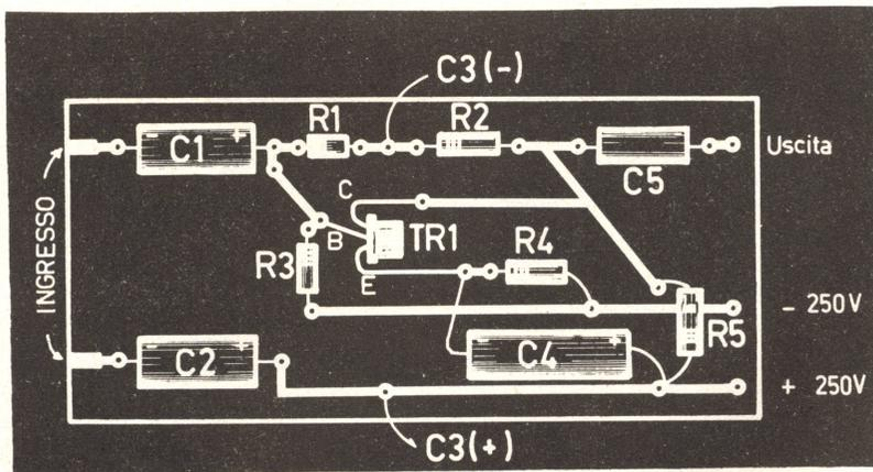
Il TRI lavora con l'emettitore comune, ed è polarizzato in controeazione da R1 ed R2. La controeazione, si verifica solo sulla corrente continua, perché C3 deriva alla massa i segnali, impedendo che dal collettore possano tornare alla base.
