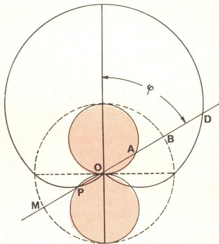
Fig. 2 - Diagramma di ricezione a cardioiderindividuazione del senso.
