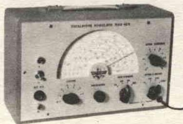
Portata a radiofrequenza: 150-390 KHz; 370-670 KHz; 2-6,9 MHz; 6,6-24 MHz; 23-92 MHz; 67-225 MHz. Tensione di uscita regolabile tramite attenuatore a decade ed attenuatore continuo. Modulazione di ampiezza interna circa il 25% a 400-800 Hz. Istruzioni di montaggio e d'uso L. 900
