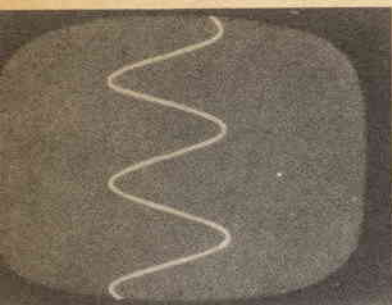
Fig. 6 Il nostro «modulatore di impulsi» vi permetterà di sfruttare il vostro comune televisore in un mastodontico oscilloscopio senza doverlo minimamente modificare. Nella foto il segnale di BF emesso da un oscillatore.
