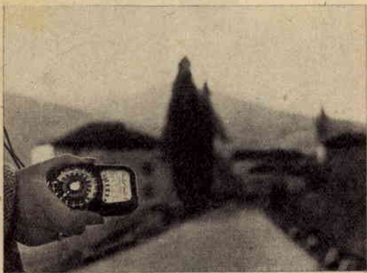
Fig. 14 - Misurazione della luce a luce riflessa: la cellula viene indirizzata verso i soggetti scuri e non verso il cielo.
