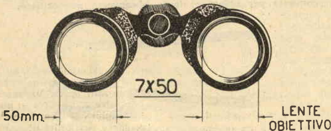
Fig. 7. — L'indicazione 7x50 sta ad indicare che il binocolo in esame ingrandisce l'immagine di 7 volte e dispone di una lente d'obiettivo del diametro di mm. 50.
