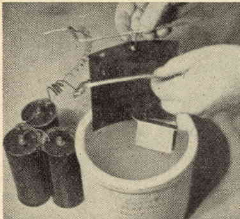
Fig. 8 - Per preparare il bagno, tutto quello che occorre ad un dilettante è un recipiente di terracotta o porcellana o vetro e tre pile, da collegare in serie. Dopo i primi tentativi, il successo è sicuro, a condizione di rispettare rigorosamente le norme. Imparare a ramare piccoli oggetti può tornare prezioso in mille occasioni. Inoltre saranno i primi passi nell'acquisizione dei segreti di una tecnica di grande importanza.
