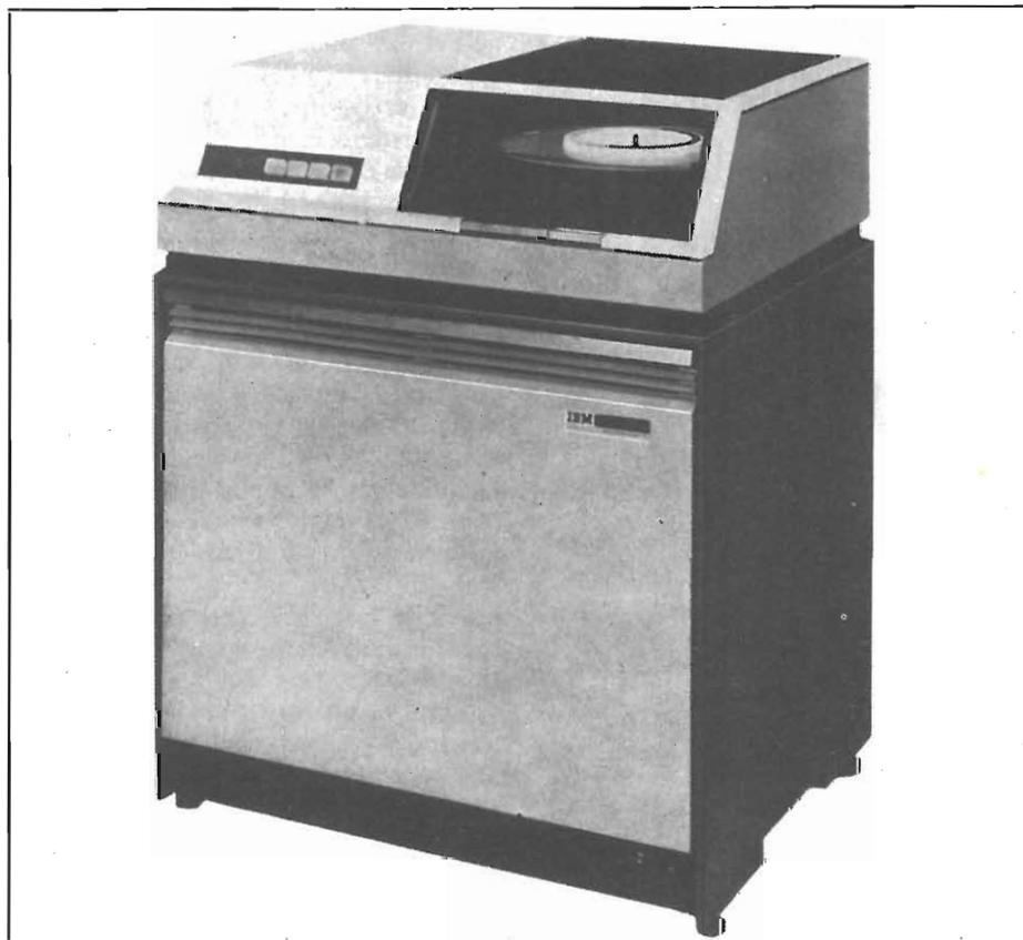
Fig. 5 - Unità a dischi magnetici intercambiabili in cui l'operatore può inserire e rimuovere un modulo composto da 6 dischi magnetici (IBM 2311 Dispac).
