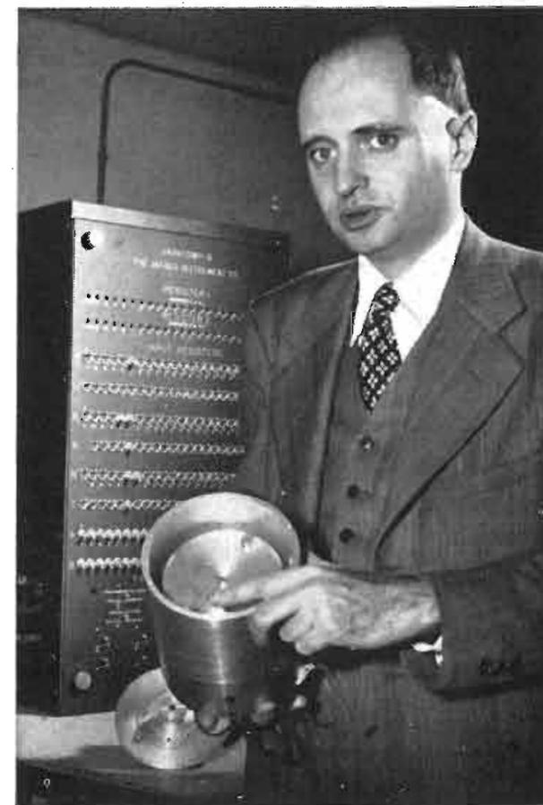
La Jacobs Instrument Company di Bethesda, ha realizzato uno speciale dispositivo che permette di convertire dati di temperatura, pressione, posizione, velocità, ecc., in impulsi elettrici che vengono inviati in una calcolatrice elettronica costruita dalla stessa ditta. La calcolatrice stima i valori delle varie quantità, esegue calcoli su di esse e sulle relazioni che intercorrono fra i dati raccolti.
