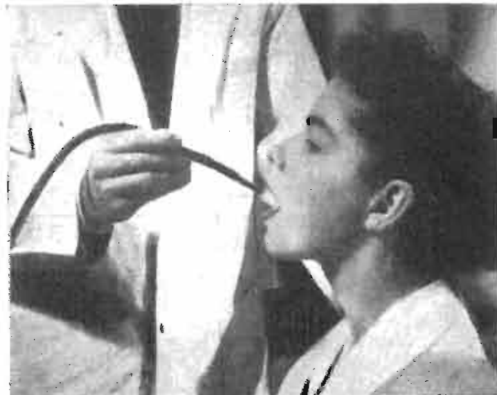
L'Oralix 21825, il minuscolo tubo per raggi X prodotto dalla Philips viene specialmente usato nella pratica odontoiatrica per eseguire radiografie dentarie.
