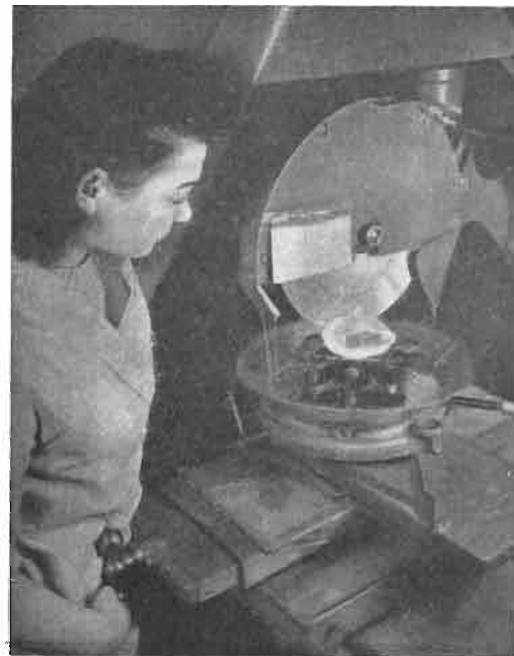
Presso la North American Philips Co., di Dobbs Ferry N.Y., si procede al taglio di una lamina di quarzo.
