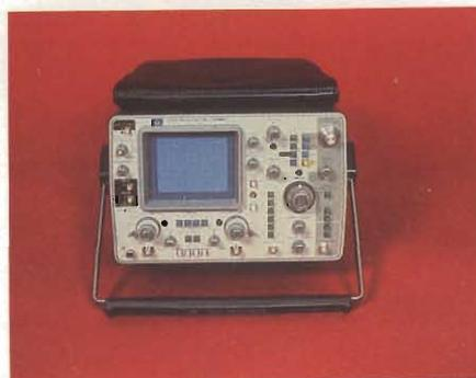
Oscilloscopio a memoria analogica Hewlett-Packard 1741 A a persistenza variabile. Differisce dal tipo 1744 A per avere una velocità di scansione inferiore, e cioè, 5 ns/div, con possibilità di espansione x 10.
