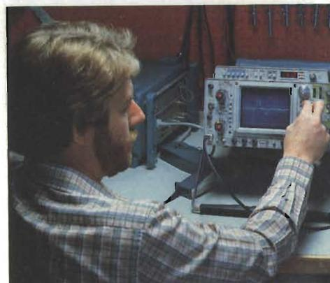
Oscilloscopio a memoria digitale Tektronix modello 468, portatile. Memorizza e presenta eventi singoli con frequenza fino a 10 MHz. Possiede un particolare sistema di interpolazione della forma d'onda. Differenze di tempo o di tensioni possono essere calibrate con estrema precisione mediante cursori spostabili sullo schermo. Opzione GP-1B (IEEE-488). Larghezza di banda "non storage": 100 MHz.
