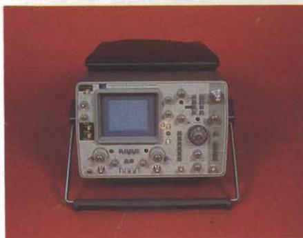
Oscilloscopio a memoria analogica Hewlett-Packard 1744A, a persistenza variabile. Larghezza di banda: 100 MHz. Tempo di salita: <math>< 3,5 \text{ ns}</math>. Velocità di scrittura 1800 cm/μs. Velocità di scansione 5 ns/div (espansione x 10). Sensibilità 1:2 mV fino a 30 MHz; 5 mV fino a 100 MHz.
