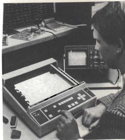
L'oscilloscopio a memoria digitale Philips PM 3305 da 35 MHz dispone ora di un software che permette di ottenere un "hard copy" del segnale visualizzato ricorrendo al plotter a sei colori PM 8154B. L'inizio della stampa della copia in colore ha luogo all'atto della pressione di un pulsante presente sul pannello frontale del PM 3305.
