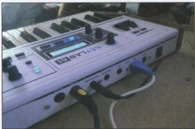
Controlliamo sul retro della nostra tastiera musicale qual è il tipo di connessione supportata. Se è presente il connettore USB, sarà sufficiente collegare un qualsiasi cavo per stampanti in cui il lato piatto va nel computer e quello simil-rettangolo alla tastiera.
