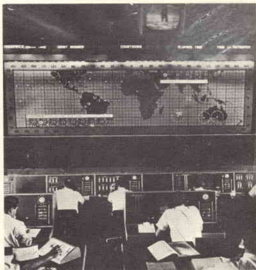
La Sala di Controllo Operativo del Centro Mercury, installato a Cape Canaveral, fornisce agli operatori ed ai monitor i dati essenziali sull'andamento della missione. Una carta geografica generale illustra le posizioni della capsula lungo i percorsi orbitali; i cerchi bianchi indicano le varie stazioni di controllo.
