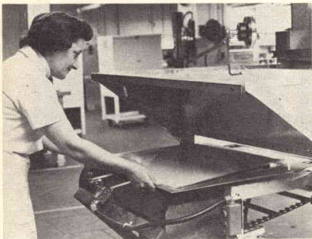
In teoria la sola limitazione alle dimensioni delle lampade è imposta dalle attrezzature per la costruzione. In fotografia si vede uno strato di fosfori cotto in un forno a raggi infrarossi.
