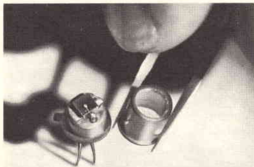
Fig. 1 - Il rivelatore fotovoltaico della Philco, denominato GAU-401, è montato in una normale custodia TO-18 per transistori, modificata in modo tale da consentire il passaggio della luce.
