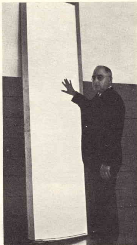
Una fra le più grandi lampade elettroluminescenti costruite negli Stati Uniti ha le dimensioni di 2,5 x 0,6 m. Essa ha una durata presunta che è di circa cinque anni.
