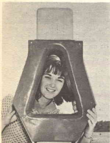
Ecco il collare per alce, per niente scomodo, impermeabile ed imbottito, che pesa 11 kg. L'antenna a dipolo è in alto.
