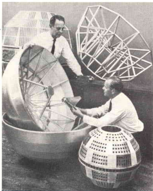
Scienziati della Bell Telephone studiano la forma e le dimensioni dei satelliti che dovranno essere realizzati per comunicazioni a relé TV e radio-telefoniche. Il modello più piccolo sarà equipaggiato con circa 4.000 pile solari, il più grande, che misurerà 4 m di diametro, con circa 12.000.
