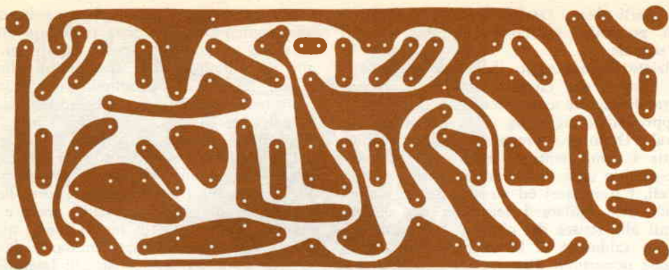
Fig. 2 - Sopra è mostrato il piano di incisione e di foratura della basetta del circuito stampato, rappresentata nelle sue dimensioni reali. A destra, sono mostrati la disposizione e l'orientamento dei componenti. Si noti l'orientamento del lato piano dei transistori ed il segno + relativo al complesso raddrizzatore ad onda intera Rect 1.
