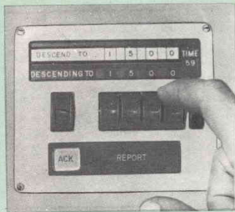
Comunicazioni fra aria e suolo, e viceversa, effettuabili azionando semplicemente un bottone diventeranno cosa normale con gli apparecchi ora in via di elaborazione. Lo strumento che si vede in figura può fornire 64 parole e frasi distinte, sufficienti per le comunicazioni di normale amministrazione.
