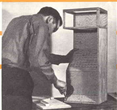
Vista del mobile che mostra il suo pannello resistivo perforato. È interessante notare che tutte le giunzioni sono incollate ed avvitate.
