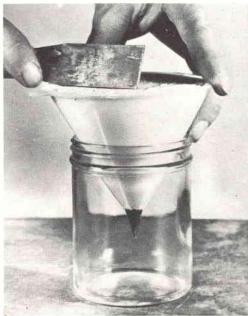
Un imbuto pieno di scagliola serve come riflettore per le alte frequenze. Si può usare un vasetto di vetro vuoto per appoggiare l'imbuto.
